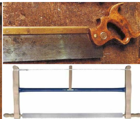
Obr. 40: Vsazená a rámová pila (Zdroje: Cook, autor)
