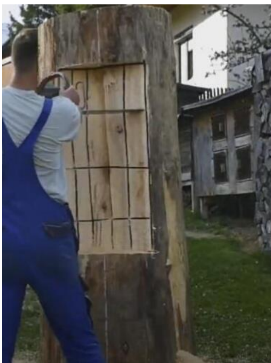
15. Po vodorovných řezech provedeme ještě svislé, abychom měli co nejmenší kusy.
