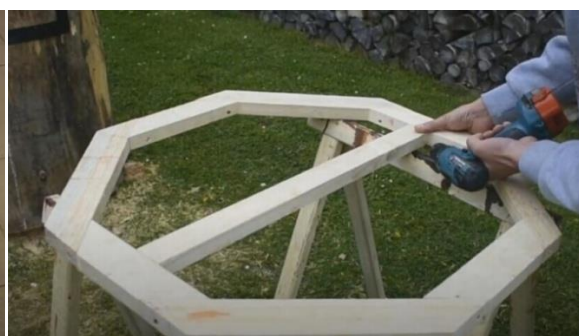
22. Celek spojíme pomocí vrutů.
