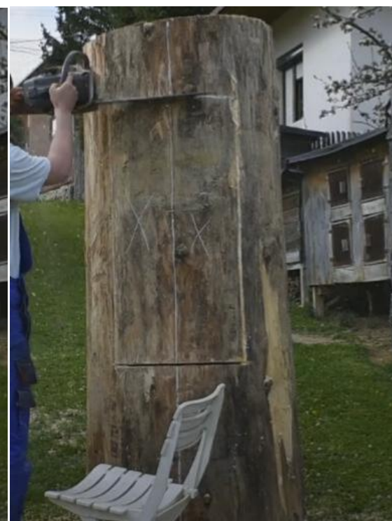
12. Prořízneme horní část, tak, aby se nám všechny řezy propojily.
