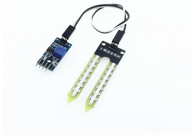
Obrázek 3.4: Senzor vlhkosti FC-28 [26]
