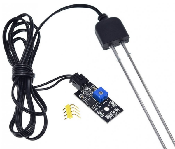
Obrázek 3.5: Senzor vlhkosti HD-38 [27]
