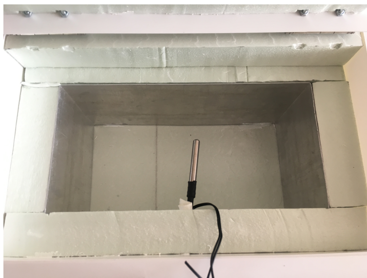
Obrázek 4.16: Dokončený chlazený prostor komory
