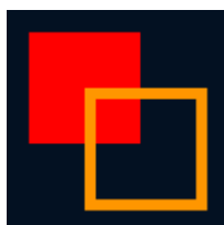
Obr. 12 - Ukázka grafického výstupu funkce Rectangle() a Frame()
