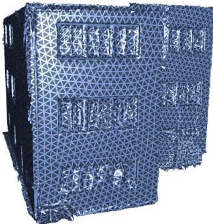
Obrázek 29: Ukázka sítě po nastavení koncového počtu trojúhelníků
