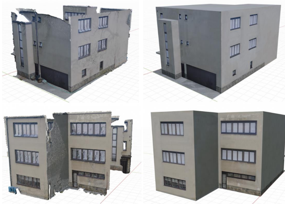
Obrázek 39: Výstupní model ze softwaru Agisoft (vlevo) a zjednodušený model s upravenou texturou (vpravo)
