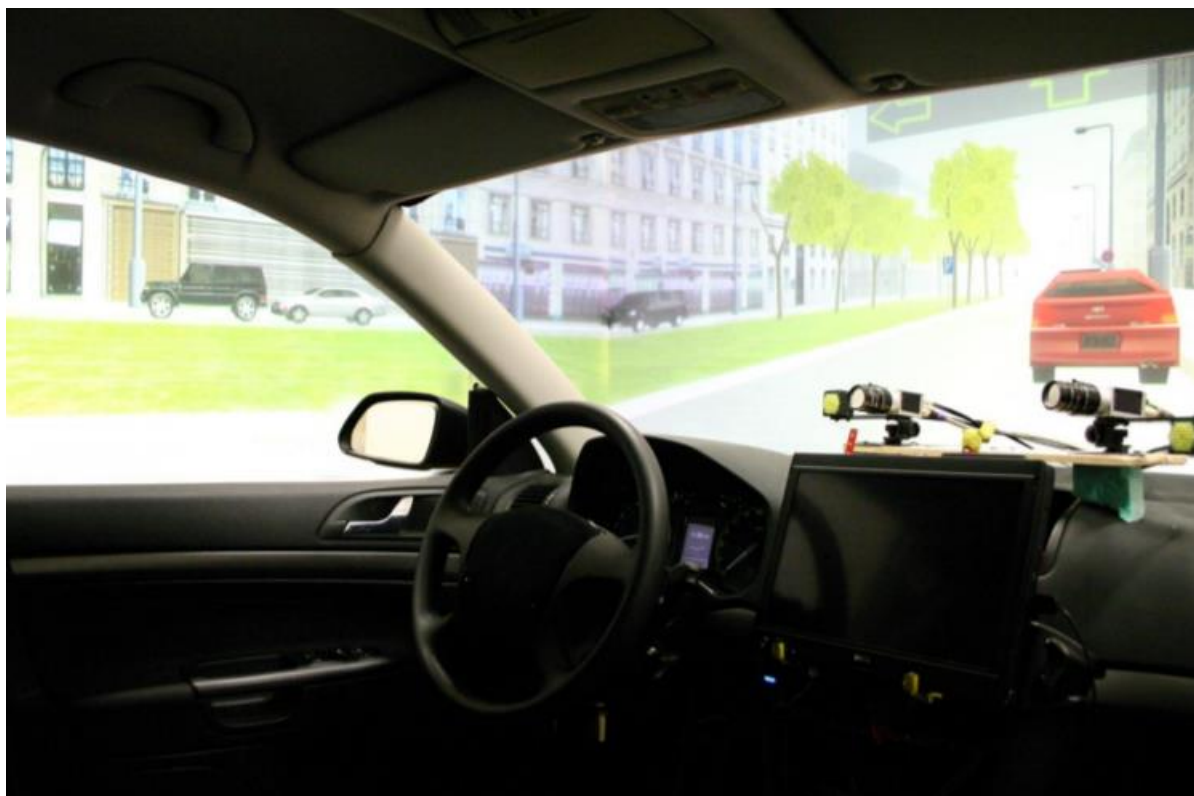
Obrázek 7: Interaktivní simulátor na Fakultě dopravní, ČVUT v Praze, zdroj [9]
