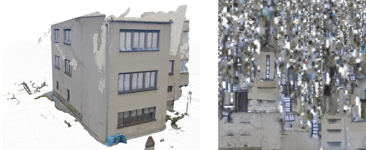
Obrázek 20: Výsledný model vytvořený v programu Agisoft (vlevo) a jeho textura (vpravo)
