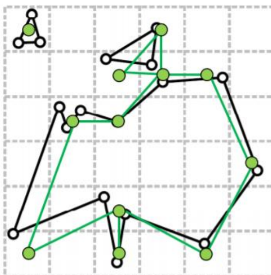
Obrázek 23: Shlukování bodů, původní vrcholy a body: černé, nově vytvořené: zelené, zdroj [24]
