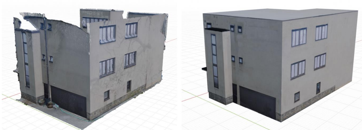
Obrázek 37: Výstupní model ze softwaru Agisoft (vlevo) a výsledný upravený model (vpravo)
