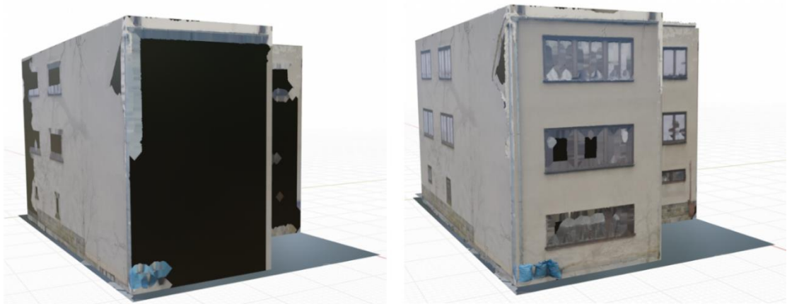
Obrázek 34: Ukázka různého nastavení "Max ray distance": nízká hodnota (vlevo) a vysoká hodnota (vpravo)
