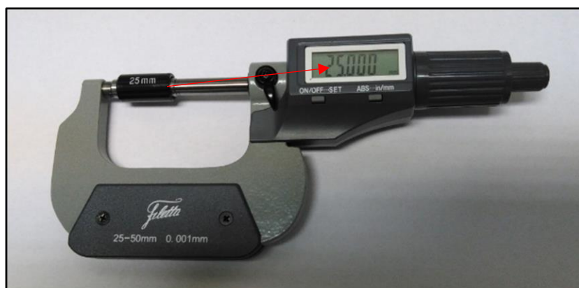
Obrázek 26: Nastavení mikrometru 25-50 mm
