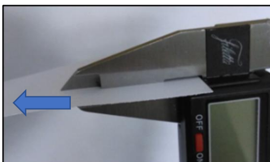
Obrázek 7: Čištění měřících ploch
