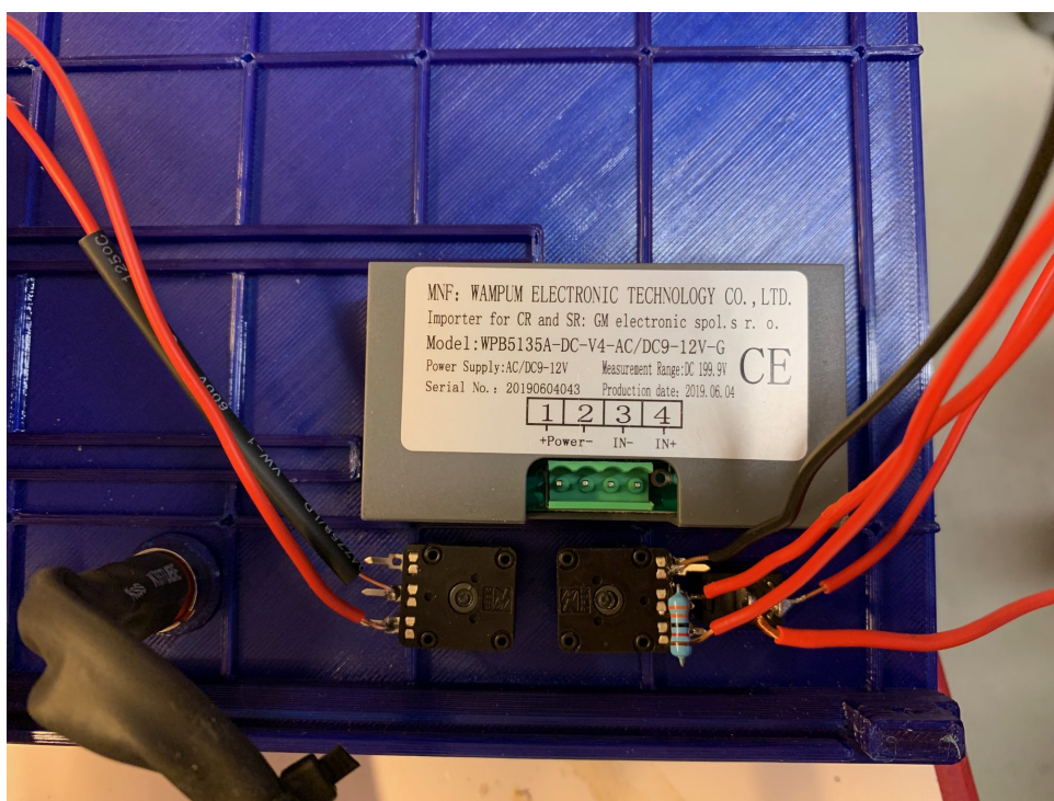
Obrázek 8.2: Omezení rozsahu potenciometru P7 rezistorem R12 (vpravo dole).
