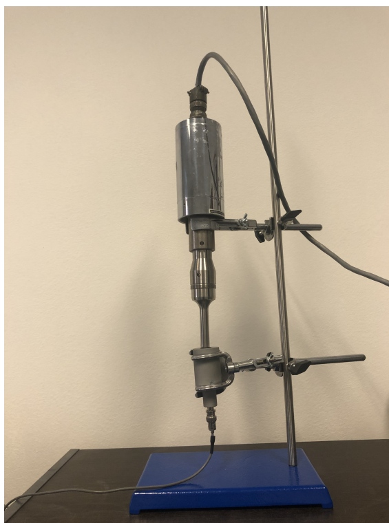
Obrázek 3.21: Měření podélných kmitů sondy 3
