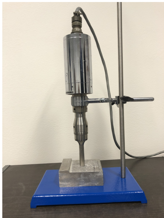
Obrázek 3.33: Sonda 3 přitlačená na 35 mm tlustý hliník
