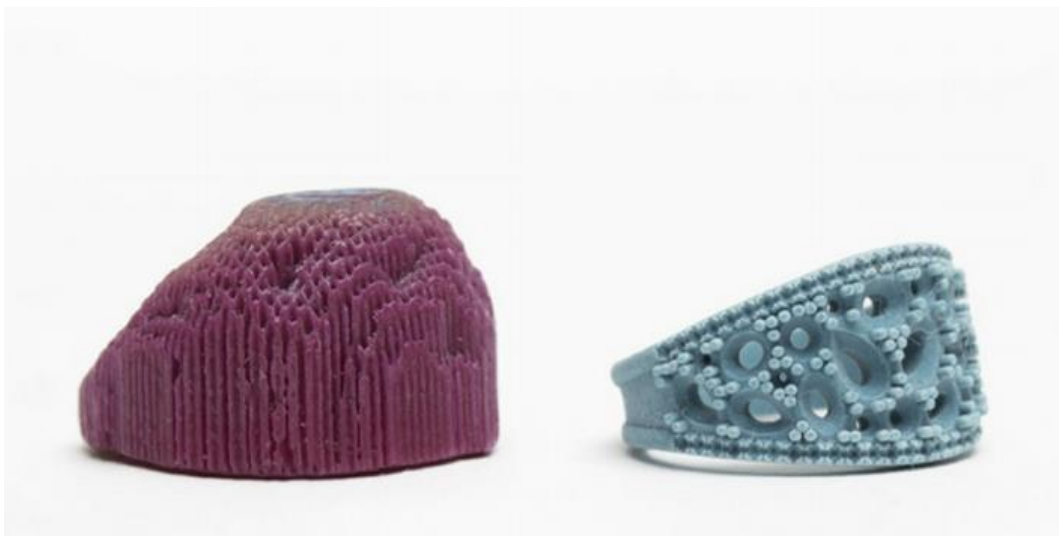
Obrázek 13: Fotografie modelu vyrobeného pomocí technologie Material jetting (vpravo) a podpěr, které se při tisku využily (vlevo) [2].
