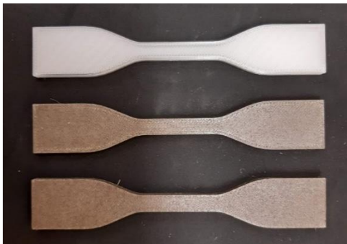
Obrázek 30: Srovnání vzorků vytisknutých z materiálů s PETG. Shora dolu – PETG, PETG-R10, PETG-R20.
