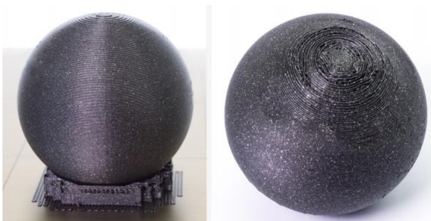
Obrázek 5: Koule vytištěná s podpěrami (vlevo) a povrch té samé koule po odstranění podpěr [1].
