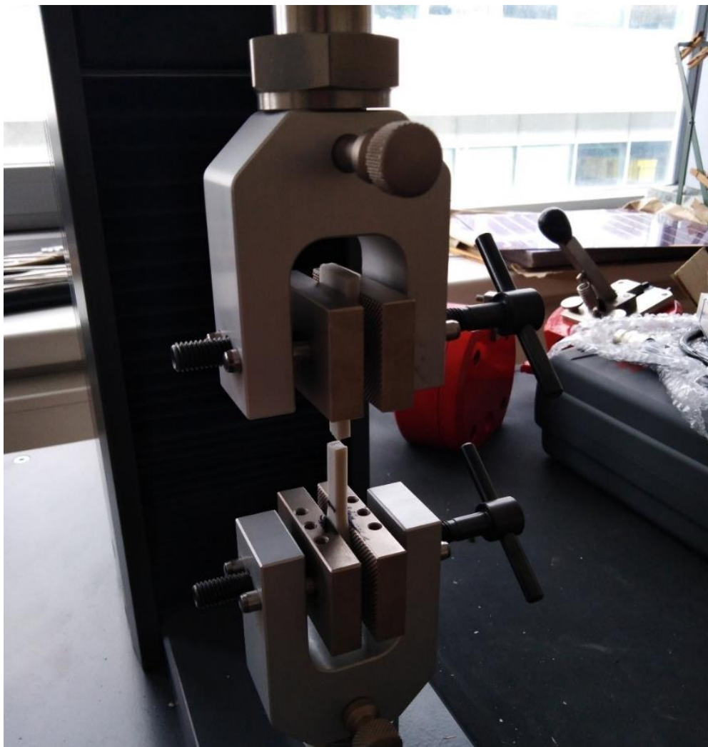
Obrázek 32: Fotografie měřícího systému síly těsně po zkoušce s roztrženým vzorkem.
