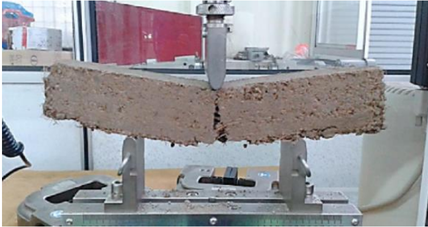
Obrázek 19: Zkouška ohybem u hliněné cihly [7].
