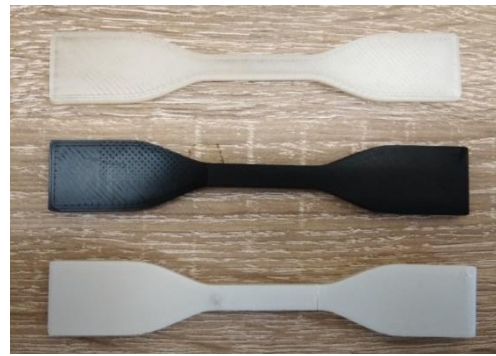
Obrázek 31: Srovnání vzorků vytisknutých z materiálů s PLA. Shora dolu – PLA, PLA-C, PLA-nD
