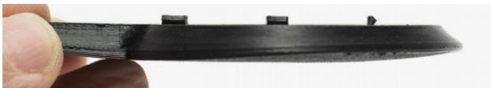
Obrázek 4: Výrobek vytištěný pomocí FFF tiskárny z ABS s pokřivením vlivem rozdílu teplot [2].
