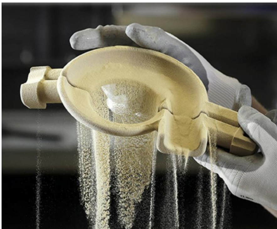
Obrázek 15: Odstraňování přebytečného prášku z výrobku vyrobeného technologií Binder Jetting [2].
