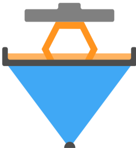
Obrázek 7: Zjednodušený DLP tisk, kde je podložka osvětlována projektorem [1].
