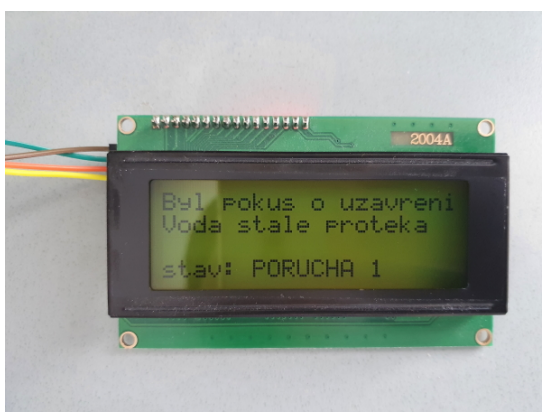
Obrázek č. 28: Zobrazení ve stavu prasklého potrubí a nedošlo k uzavření ventilu
