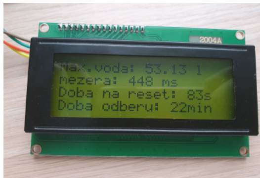
Obrázek č. 30: Zobrazení hlídaných parametrů nastavených trimry
