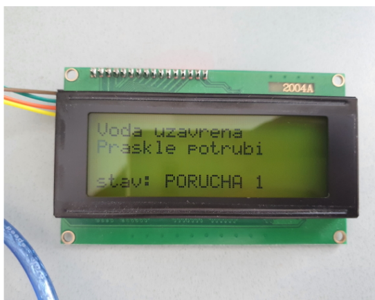
Obrázek č. 27: Zobrazení ve stavu porucha 1 - prasklé potrubí
