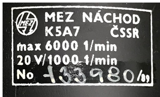
Obr. 4 - 14 Štítek tachodynamu nainstalovaného na motoru Reliance C1811ATZ
