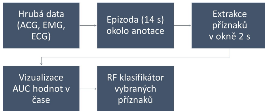
Obrázek 2.12. Schéma předzpracování aktigrafického a polysomnografických signálů: Dle jednotlivých bloků lze vidět, jaké kroky byly provedeny k závěrečné extrakci příznaků pro Random forest klasifikaci.
