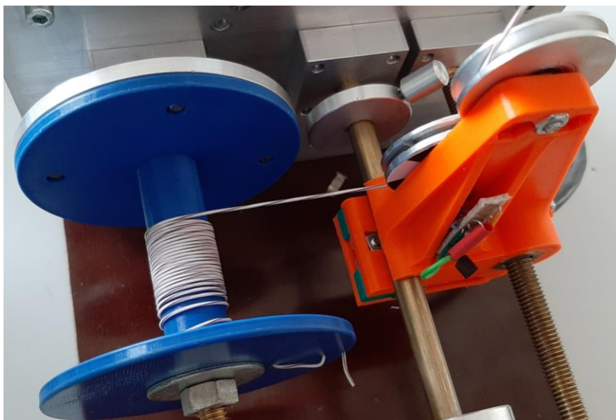
Obr. 2-28 Navíječka na konci navíjení (windingStep 0,82 mm)
