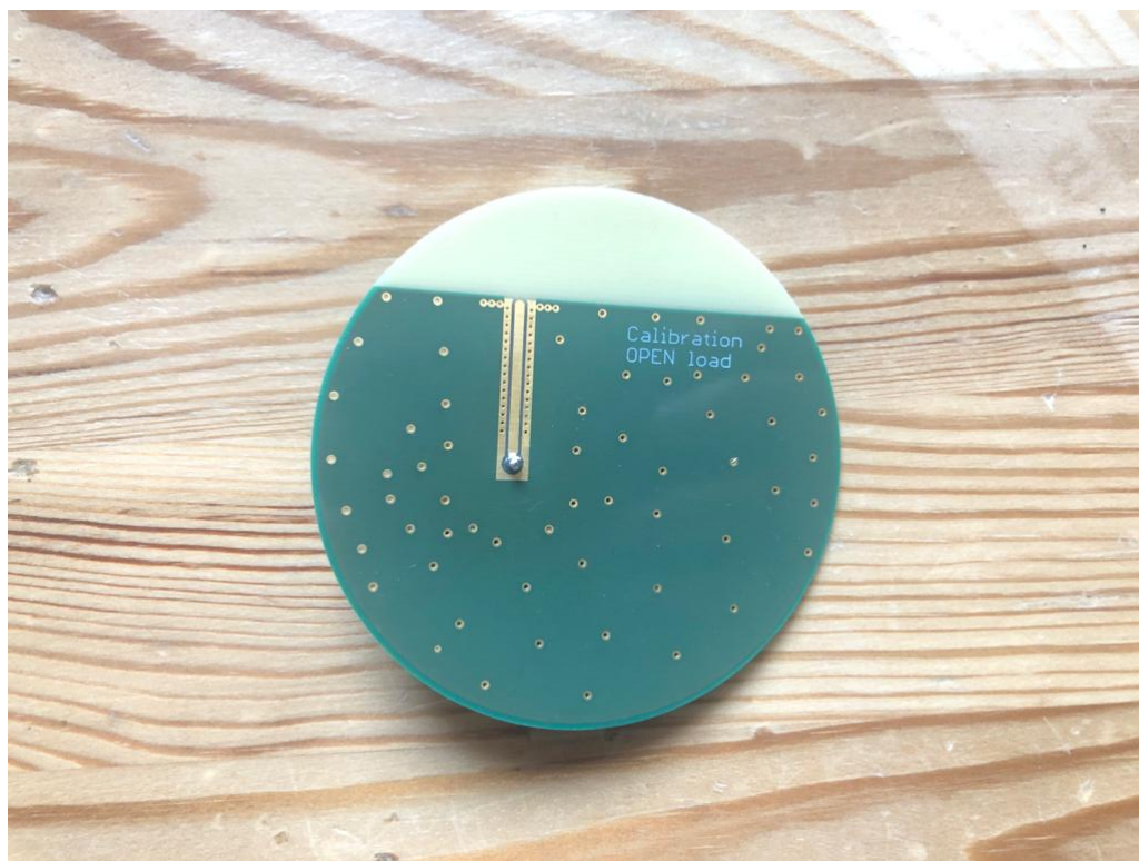
Obrázek 4.1: Deska pro kalibraci OPEN
