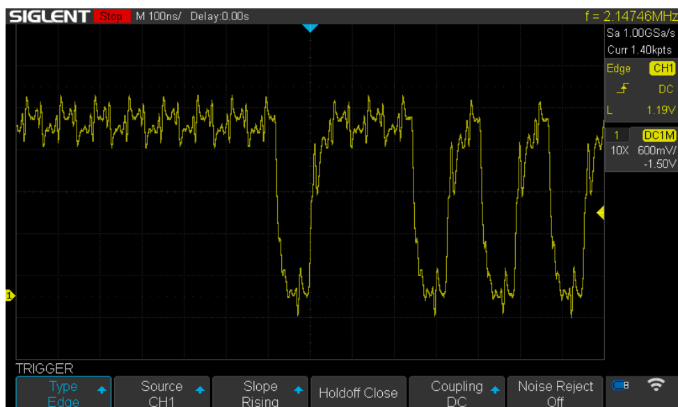
Obrázek F.0.4: Test připojení 8 mikrofonů k signálovému procesoru ADAU1452 - snímek signálu DATA na konci vedení s připojeným terminačním rezistorem 330 Ω
