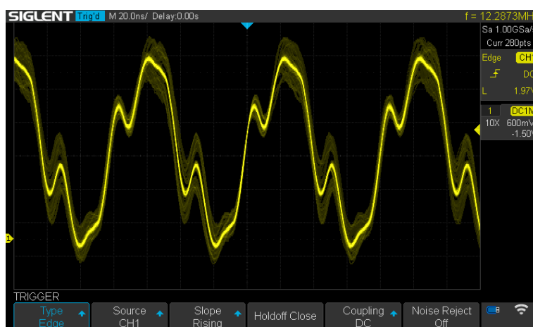
Obrázek F.0.1: Test připojení 8 mikrofonů k signálovému procesoru ADAU1452 - snímek signálu SCK na konci vedení bez připojeného terminačního rezistoru
