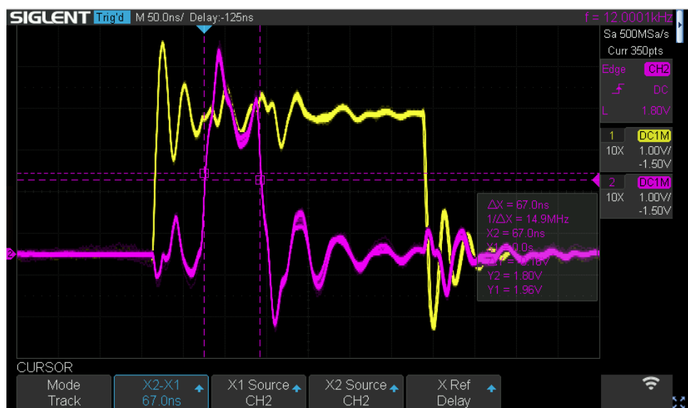
Obrázek 6.1.2: Impuls signálu WS, vystupující z TDM adaptéru při testování jeho funkčnosti
