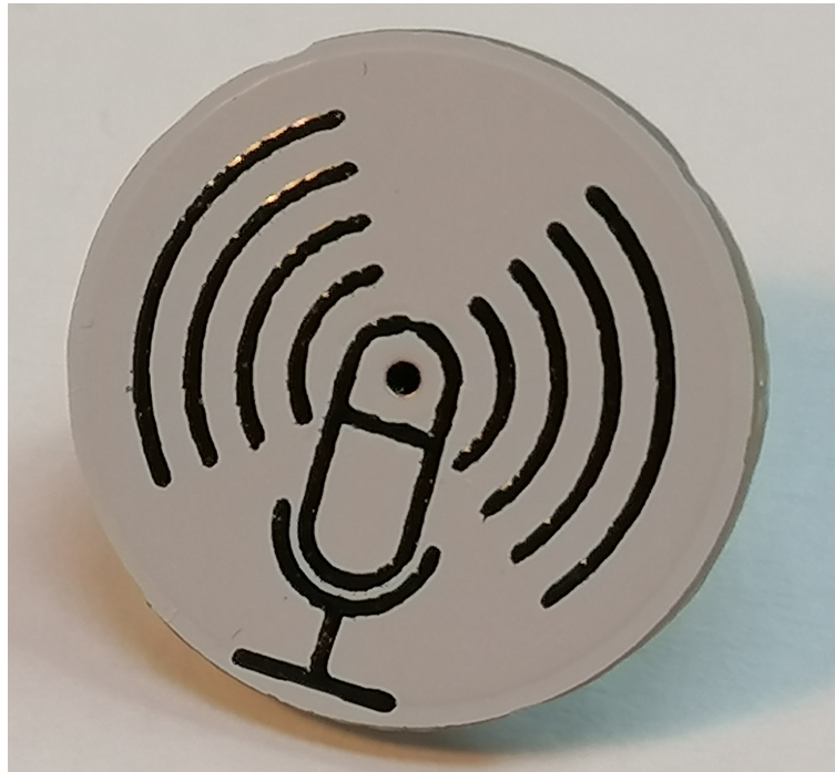
Obrázek C.0.3: Zadní strana DPS pro MEMS mikrofon, která po instalaci lícuje s vnější plochou sférického pole
