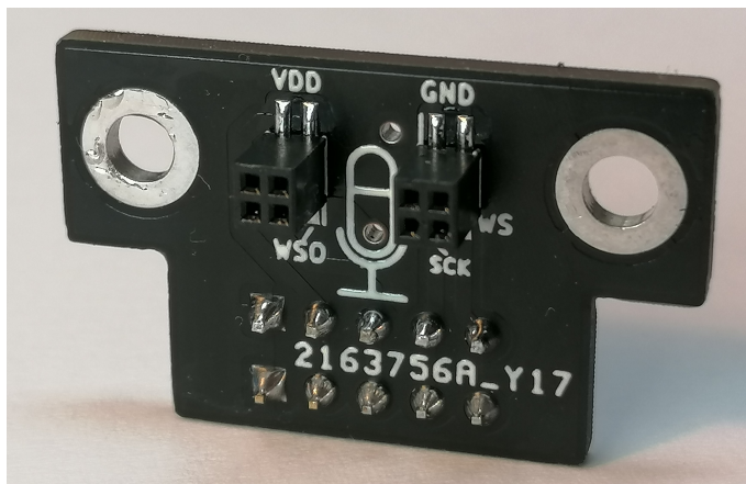
Obrázek 3.2.3: Vyrobenný a osazený plošný spoj pro montáž do tištěné konstrukce
