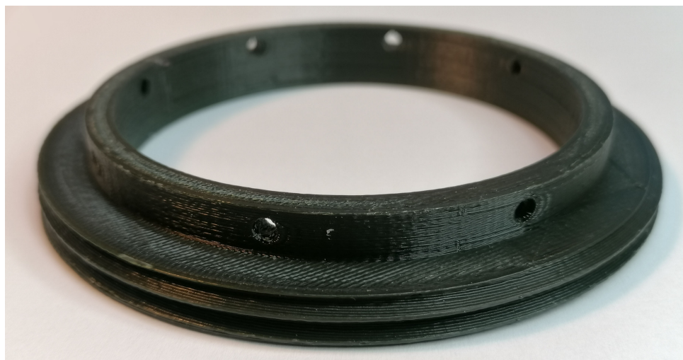
Obrázek D.0.7: Hotová spojka pro konstrukční spojení obou polosfér, zhotovená prostřednictvím 3D tisku z materiálu ABS
