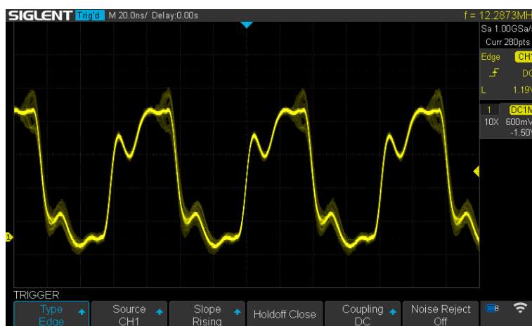
Obrázek F.0.2: Test připojení 8 mikrofonů k signálovému procesoru ADAU1452 - snímek signálu SCK na konci vedení s připojeným terminačním rezistorem 330 \Omega
