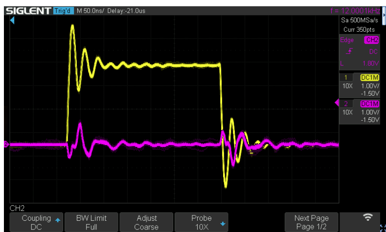
Obrázek E.0.1: Test přeslechu na TDM adaptéru mezi vstupním LRCLK signálem a výstupním signálem WS, v době, kdy signál LRCLK obsahuje signální impuls a signál WS má zůstat na úrovni nulového napětí
