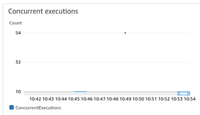
Obrázek 6.1: Zátěžový test - škálování Lambda funkcí (vytvořeno pomocí AWS Cloudwatch)
