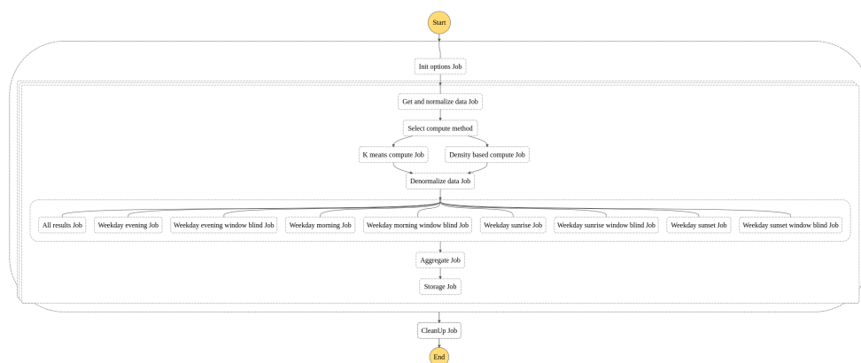
Obrázek 5.1: Celý proces tvorby doporučení (vytvořeno pomocí AWS Step functions diagramu)
