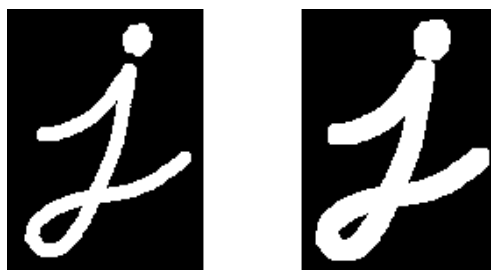
Obrázek 2.10: Vlevo původní stav, vpravo stav po aplikaci dilatace. [9]
