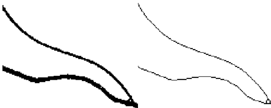
Obrázek 4.11: Vlevo problém, který může nastat pokud je koryto řeky úzké a hráze jsou na obou stranách řeky. Vpravo opravení odečtením bodů, které jsou nižší, než jejich okolí.
