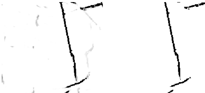
Obrázek 4.8: Vlevo po ukázka predikce, kde každý pixel nese hodnotu pravděpodobnosti, že se na jeho poloze nachází hráz. Vpravo ukázka predikce po binarizaci.
