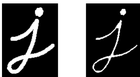
Obrázek 2.11: Vlevo původní stav, vpravo stav po aplikaci eroze. [9]
