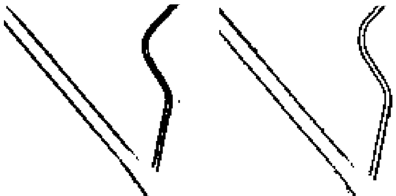
Obrázek 4.11: Vlevo problém, který může nastat pokud je koryto řeky úzké a hráze jsou na obou stranách řeky. Vpravo opravení odečtením bodů, které jsou nižší, než jejich okolí.
