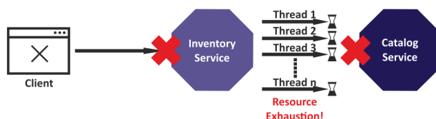
Obrázek 4.17: Vyčerpání zdrojů při mnohonásobném dotazování
