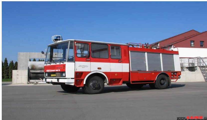
Obrázek 6 - CAS K25 na podvozku Liaz 18.29 XA 4x4 [Zdroj: Liaz.cz]
