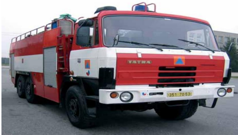
Obrázek 4: CAS 32 na podvozku Tatra 815 PR2 6x6 sloužící u VHJ AČR [15]
