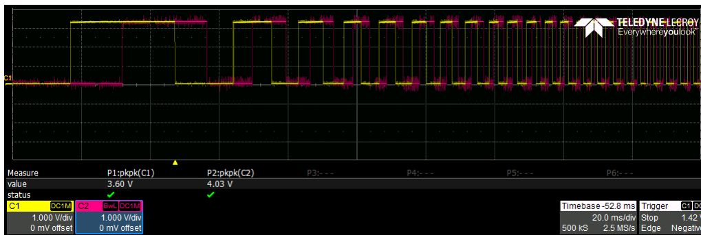
Obrázek 6.2: Kvadraturní výstup senzoru úhlu při rozběhu motoru
