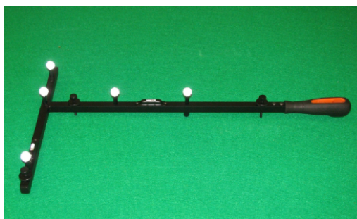
Obrázek 1.3: Vicon kalibrační hůlka s 5 markery Zdroj: Utrecht Multi-Person Motion (UMPM) benchmark [8]
