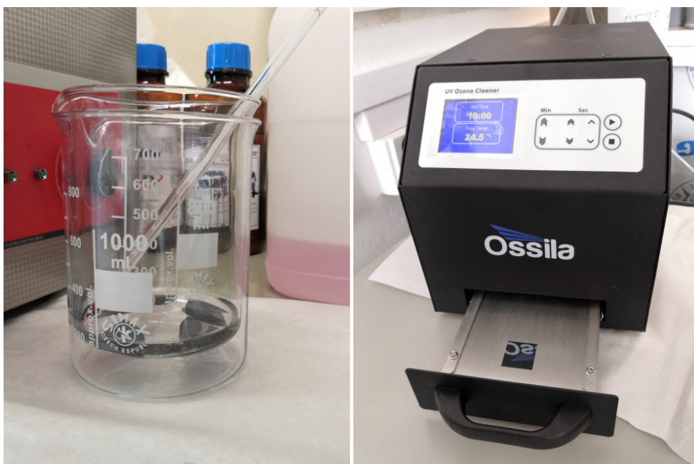
Obrázek 3.6: Čištění křemíkových substrátů, vzorky čištěné pomocí roztoku piraňa a jejich umístování do UV ozonové čističky
