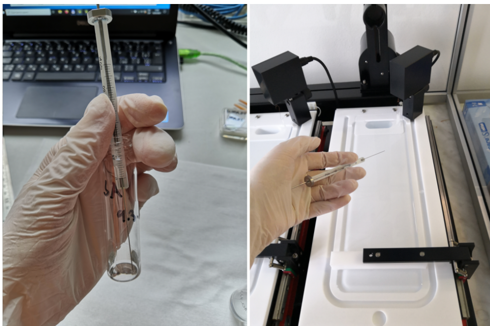
Obrázek 3.10: Technika Langmuir-Blodgettové, nanášení aktivní vrstvy kyseliny stearové (SA)
