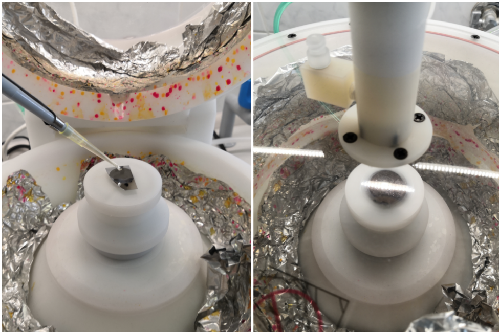
Obrázek 3.9: Metoda spin-coating , nanášení připraveného roztoku na vzorek a proces nanášení při rychlosti 1000 RPM
