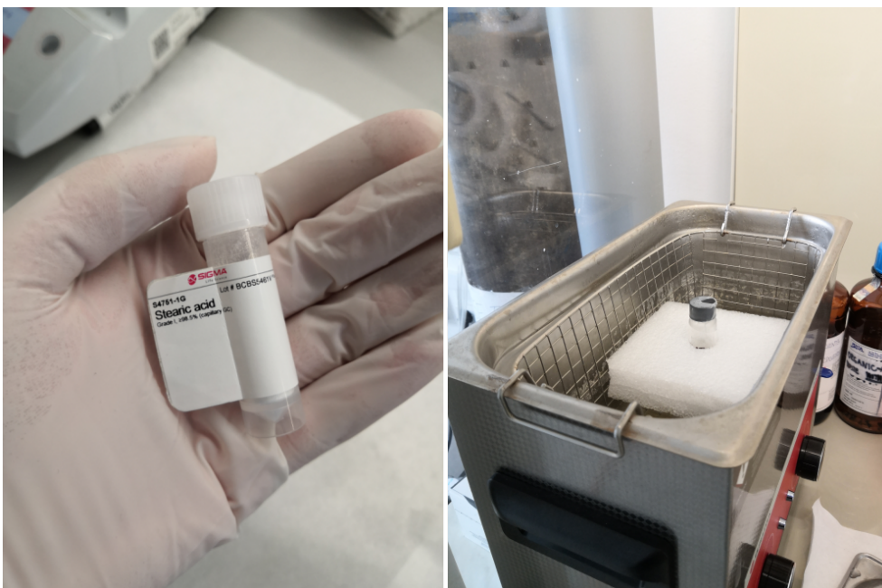
Obrázek 3.4: Příprava roztoku kyseliny stearové (SA) rozpuštěné v chloroformu a využití ultrazvukové čističky
