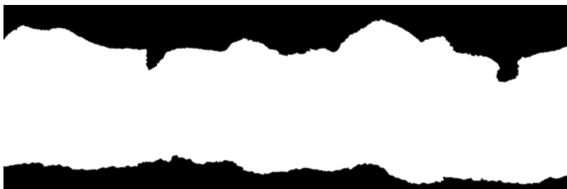
Obrázek 26 Binary select – klasifikace tavidla ROL0 – poměr tavidla v pájecí pastě 20 % – doba stárnutí 1000 h – šířka pájecí plošky 3 mm
