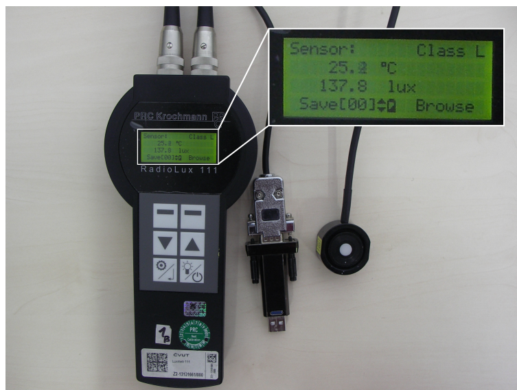
Obrázek 1.6: Luxmetr PRC Krochmann RadioLux 111 – vpravo je senzor osvětlenosti, uprostřed je redukce vedoucí do USB, která se připojuje do řídicího počítače, vpravo nahoře je zvětšený náhled displeje luxmetru během měření
