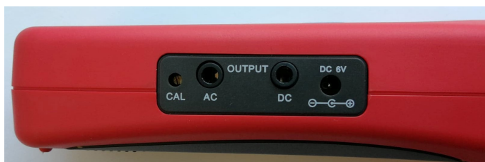
Obrázek 3.6: Boční panel pro konektory hlukoměru UNI-T UT351. Zleva, kalibrační zdířka, výstup střídavého napětí, výstup stejnosměrného napětí, externí napájení hlukoměru.
