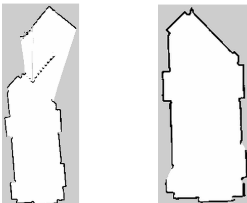
Obrázek 4.2: Mapy prázdné chodby rodinného domu získané pomocí knihovny map_server . Černá barva značí stěnu, bílá volný prostor a šedá prostor mimo měřenou místnost. Přibližná velikost chodby je 5\text{ m} \times 2\text{ m} . Vlevo otevřený přístup ke schodišti, vpravo uzavřený.
