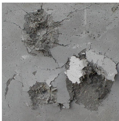
Obr. 102 Deska tloušťky 8 cm s krátery od střel ráže 7,62×54R mm FMJ s ocelovým jádrem [119].
