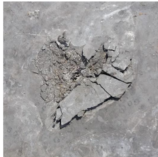
Obr. 92 Částečný scabbing na UHPFRC desce s projektilům uvíznutým uvnitř.
