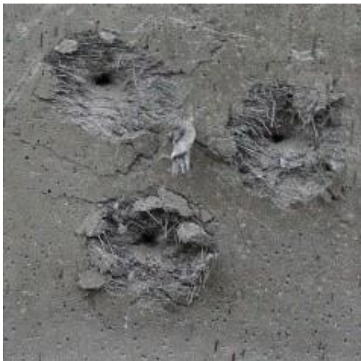
Obr. 99 Přední strana desky tloušťky 5 cm s krátery po zásahu kalibrem 7,62×39 mm s ocelovým jádrem, spodní byl perforován, dva horní nikoli [119].
