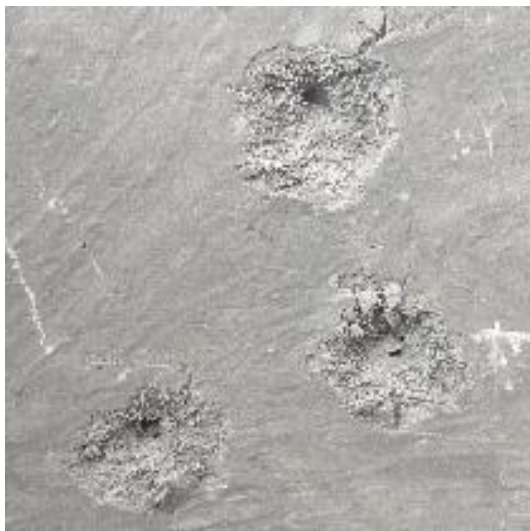
Obr. 104 Od shora zásahy kalibry 7,62×51 mm s olověným jádrem, 7,62×54R mm s ocelovým jádrem a 7,62×51 mm s ocelovým jádrem na přední straně UHPFRC desky s 4,7 % vláken.
