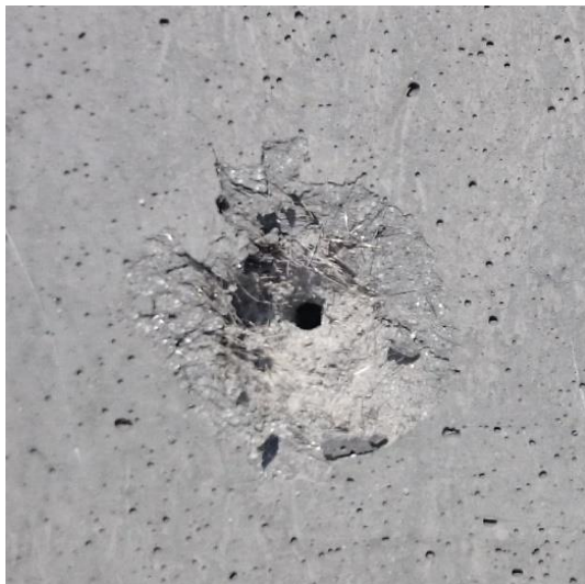
Obr. 93 Přední strana UHPFRC desky, kde došlo k perforaci.
