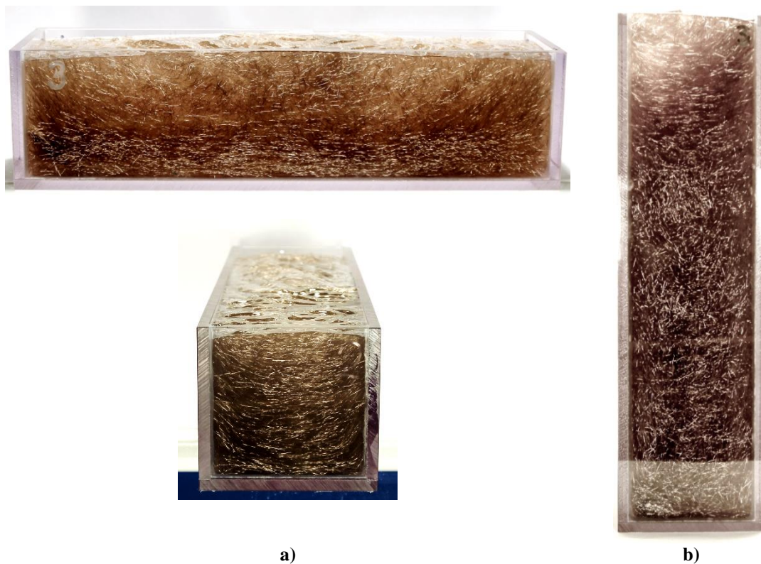
Obr. 54 Vodorovně (a) a svisle (b) orientované transparentní bednění se směsí sonogelu s drátky.
