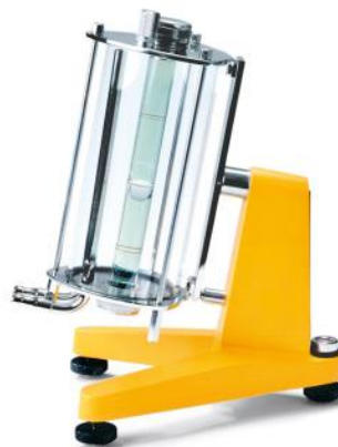
Obr. 5 Höpplerův typ viskozimetru na principu padající kuličky pro jednoduché a přesné měření dynamické viskozity průhledných Newtonovských tekutin [11].
