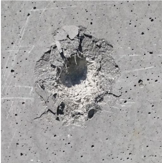
Obr. 89 Kuželovitý kráter na přední straně UHPFRC desky ze svisle orientovaného bednění.
