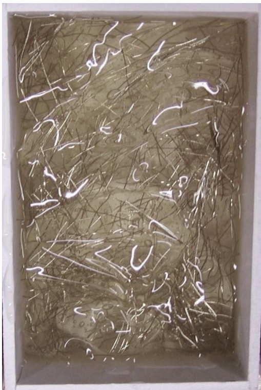
Obr. 110 Vzorek sonogelu s náhodně rozptýlenými vlákny před průchodem magnetickým polem.
