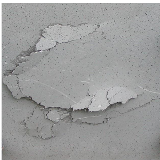
Obr. 101 Odchlipující se část zadní strany desky tloušťky 7 cm po zásahu tří střel ráže .308 [119].
