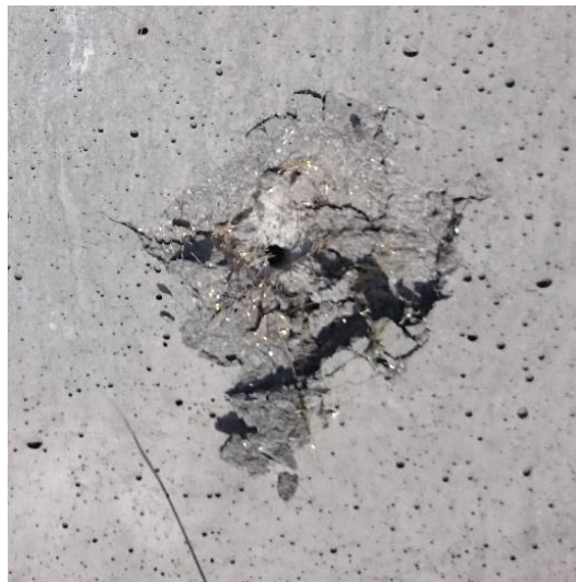
Obr. 94 Zadní strana UHPFRC desky, kde po perforaci došlo ke scabbingu.
