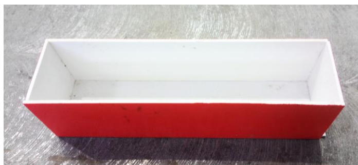
Obr. 112 Plastová forma na výrobu UHPFRC vzorků určených k magnetické orientaci.
