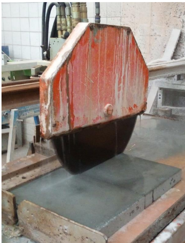
Obr. 64 UHPFRC desky během procesu řezání, v tomto případě každá na čtyři zkušební vzorky.
