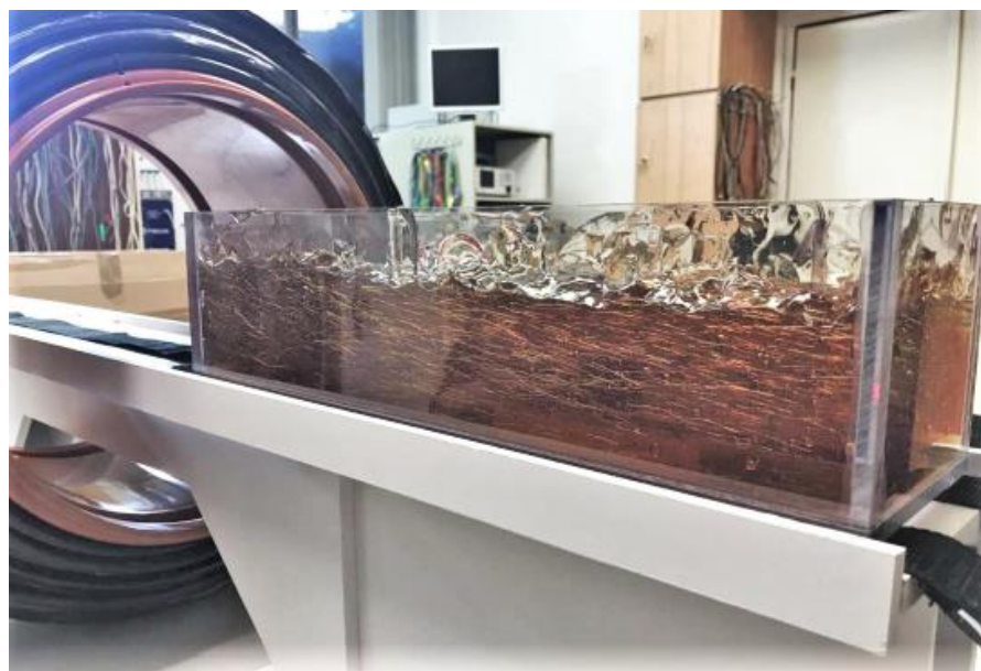
Obr. 116 Úspěšné otestování funkčnosti většího cívkového modelu pomocí sonogelu s ocelovými vlákny (100×100×400 mm) [148].
