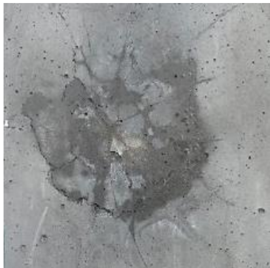
Obr. 85 Zadní strana UHPFRC desky, kde materiál zůstal po zásahu přichycen [111].
