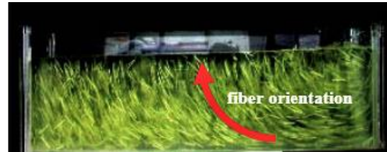
Obr. 27 Orientace PVA vláken v transparentní směsi ukládané do formy z pravé strany [62].
