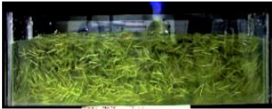
Obr. 26 Orientace PVA vláken v transparentní směsi pohyblivým naplňováním formy [62].
