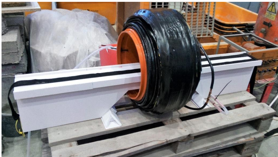
Obr. 115 Model na principu cívky soužící k magnetické orientaci vláken v čerstvé směsi UHPFRC.
