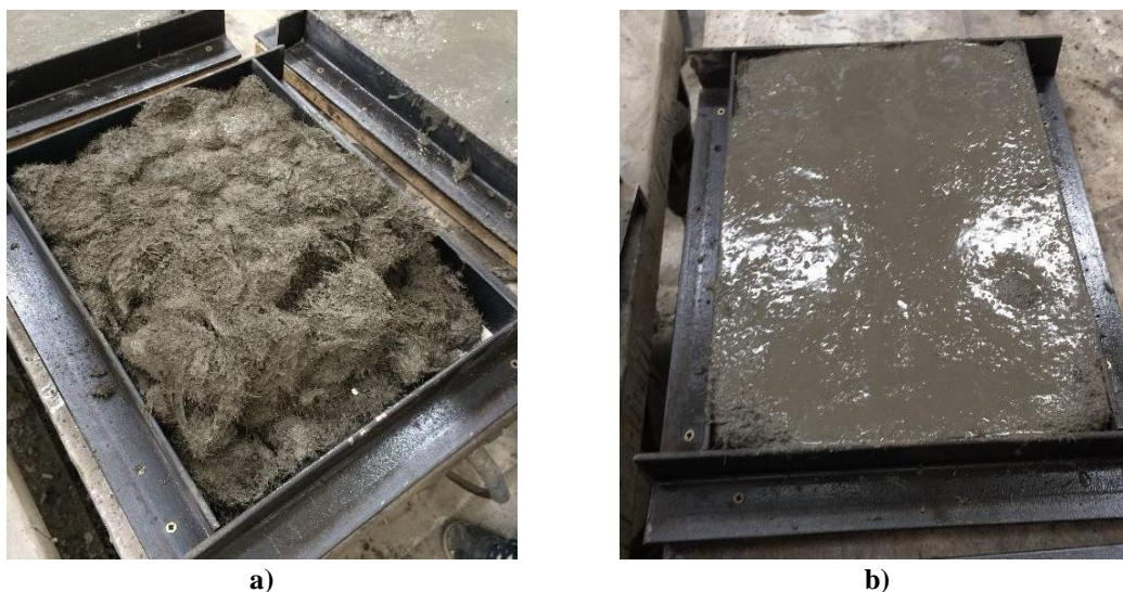
Obr. 103 Proces „lítí“ do bednění, a) směs UHPFRC s 4,7 % ocelových vláken po umístění do formy a b) po zavibrování [121].
