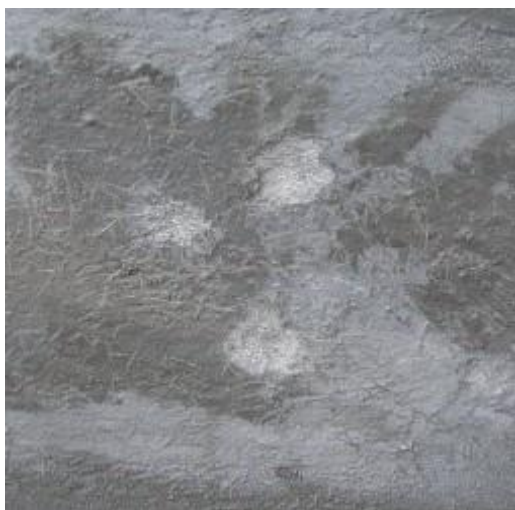
Obr. 97 Deska tloušťky 3 cm po zásahu ráží 9×19 mm Luger na levé straně a dva zásahy od 62×25 mm Tokarev na pravé straně [119].
