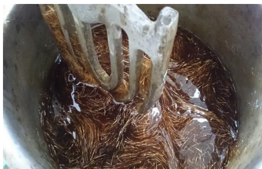
Obr. 52 Příprava směsi sonogelu s vlákny.
