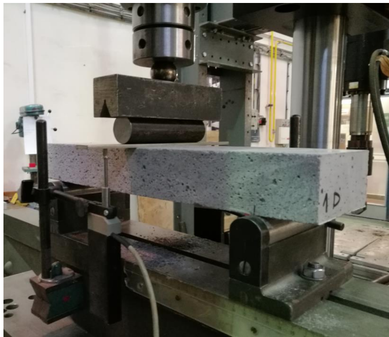
Obr. 66 Zkouška tříbodovým ohybem na mechanickém zatěžovacím rámu.
