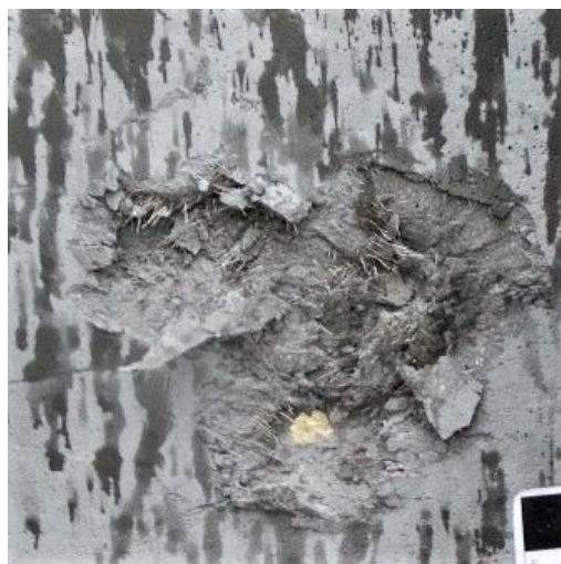
Obr. 98 Zadní strana desky tloušťky 4 cm s krátery po zásahu kalibrem 7,62×39 mm s olověným jádrem, spodní byl perforován, dva horní nikoli [119].
