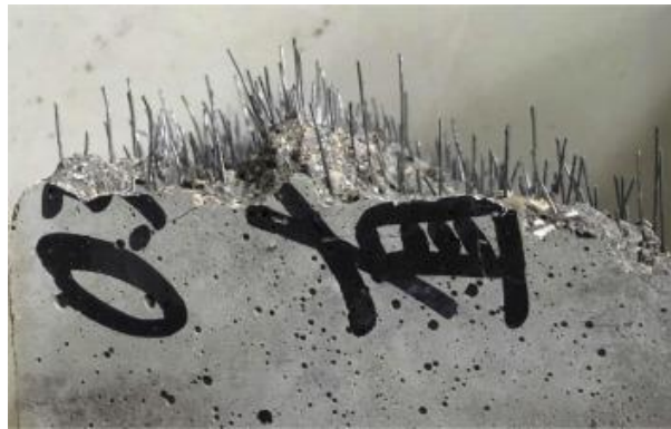
Obr. 37 Orientace vláken v prasklé části vzorku [54].
