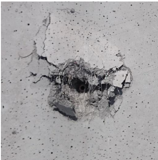
Obr. 91 Kráter s uvíznutým projektilům na přední straně UHPFRC desky ze svisle orientovaného bednění.
