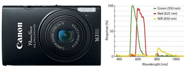
Obrázek 9: Kamera Canon PowerShot ELPH 110 HS se spektrálními křivkami.
