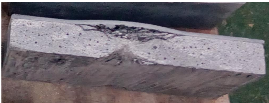
Obr. 87 Řez vzorkem s úpravou Paxcon na výstupní straně (2 mm)
