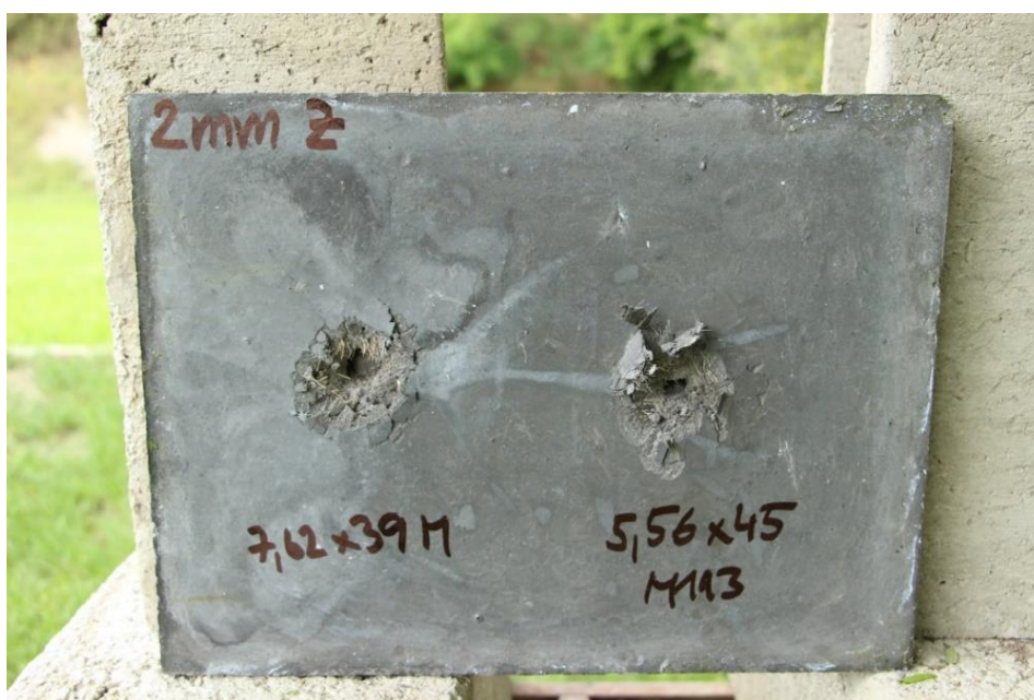
Obr. 86 Vrstva nástřiku 2 mm na výstupní straně vzorku
