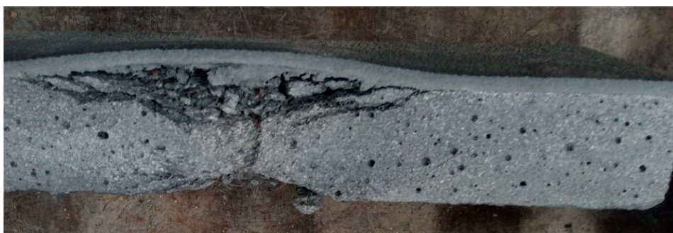
Obr. 91 Řez vzorkem s úpravou Paxcon na výstupní straně (4 mm)
