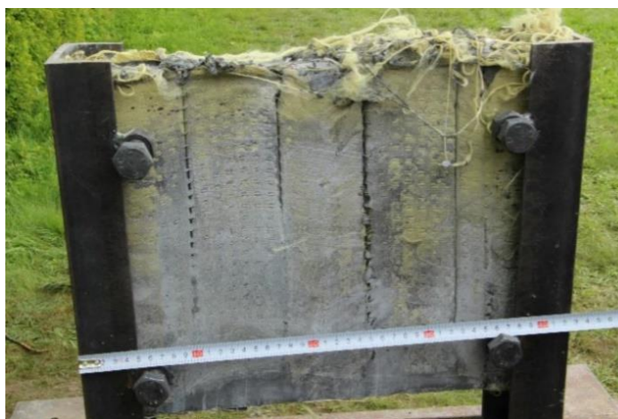
Obr. 51 Speciální kotvící konstrukce pro usazení testovaných vzorků
