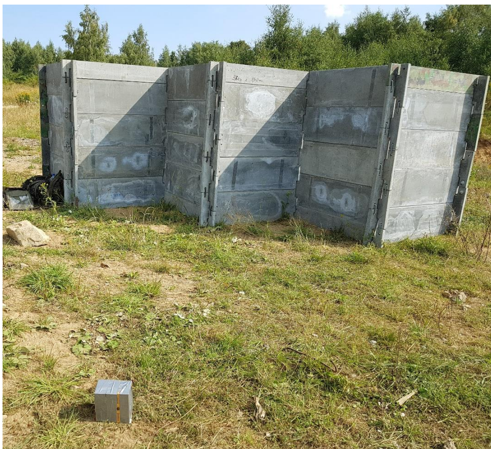
Obr. 101 Sestava pro testování odolnosti proti výbuchu
