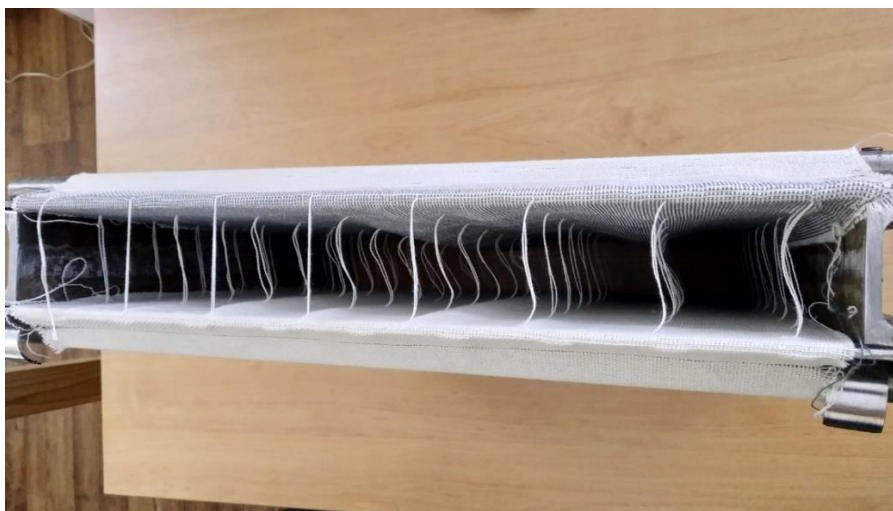
Obr. 47 Upevnění tkaniny do formy
