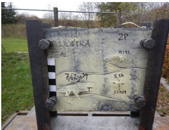
Obr. 83 Penetrovaná testovací deska
