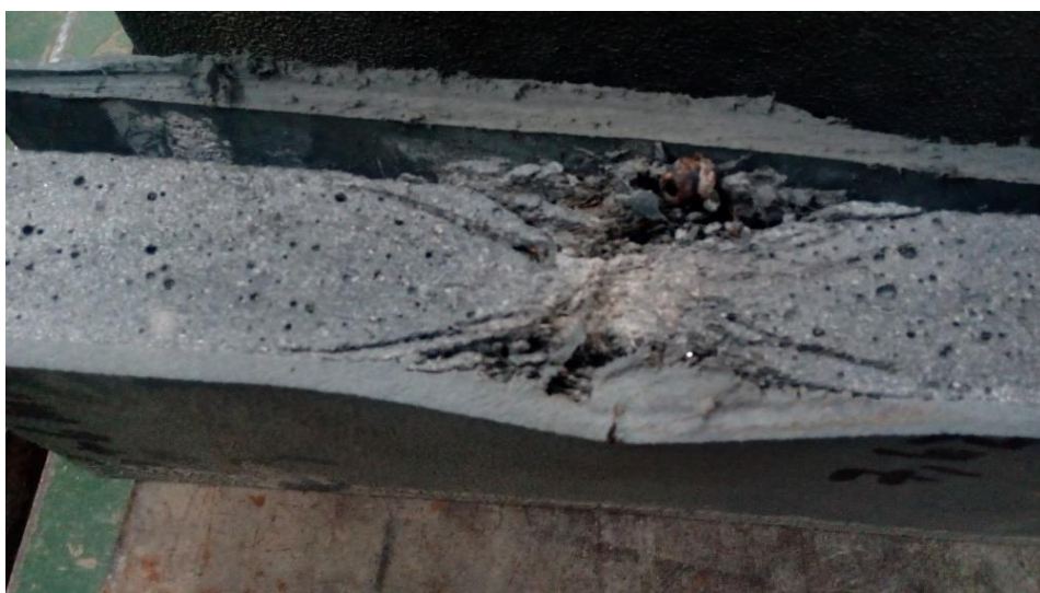
Obr. 90 Řez vzorkem s úpravou Paxcon při obou površích
