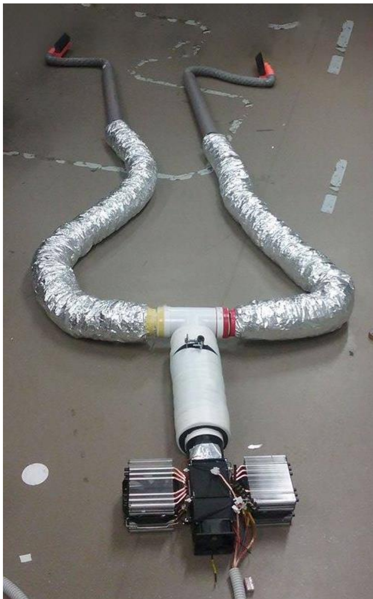
Obr. 103: Kompletně smontovaný systém MKJ-1 (mezi jednotkou a odbočkou je vložený měřící kus) (zdroj: autor).
