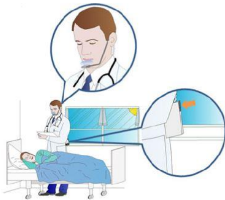
Obr. 22: Personalizované větrání nemocničních lůžek [1]
