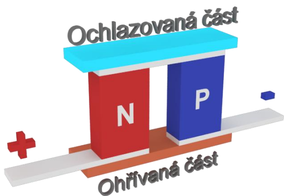
Obr. 58: Princip fungování Peltierova článku za použití polovodičů P a N. (Zdroj: Autor)
