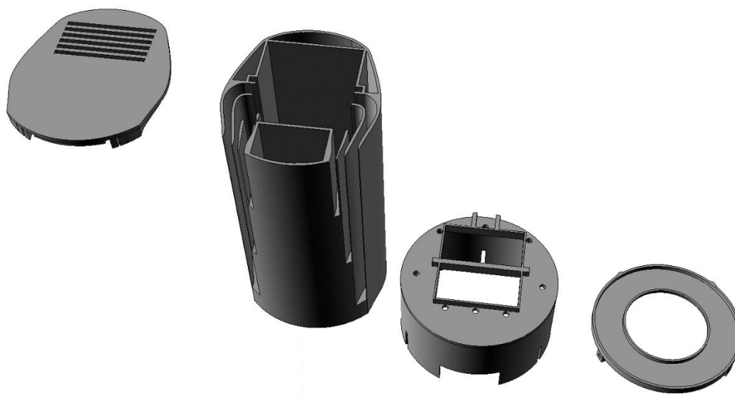
Obr. 108: Díly těla MKJ-2 vyrobené 3D tiskem (Zdroj: autor)
