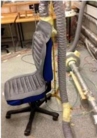
Obr. 18: větraná matrace pro odsávání škodlivin z osobní zóny [59]
