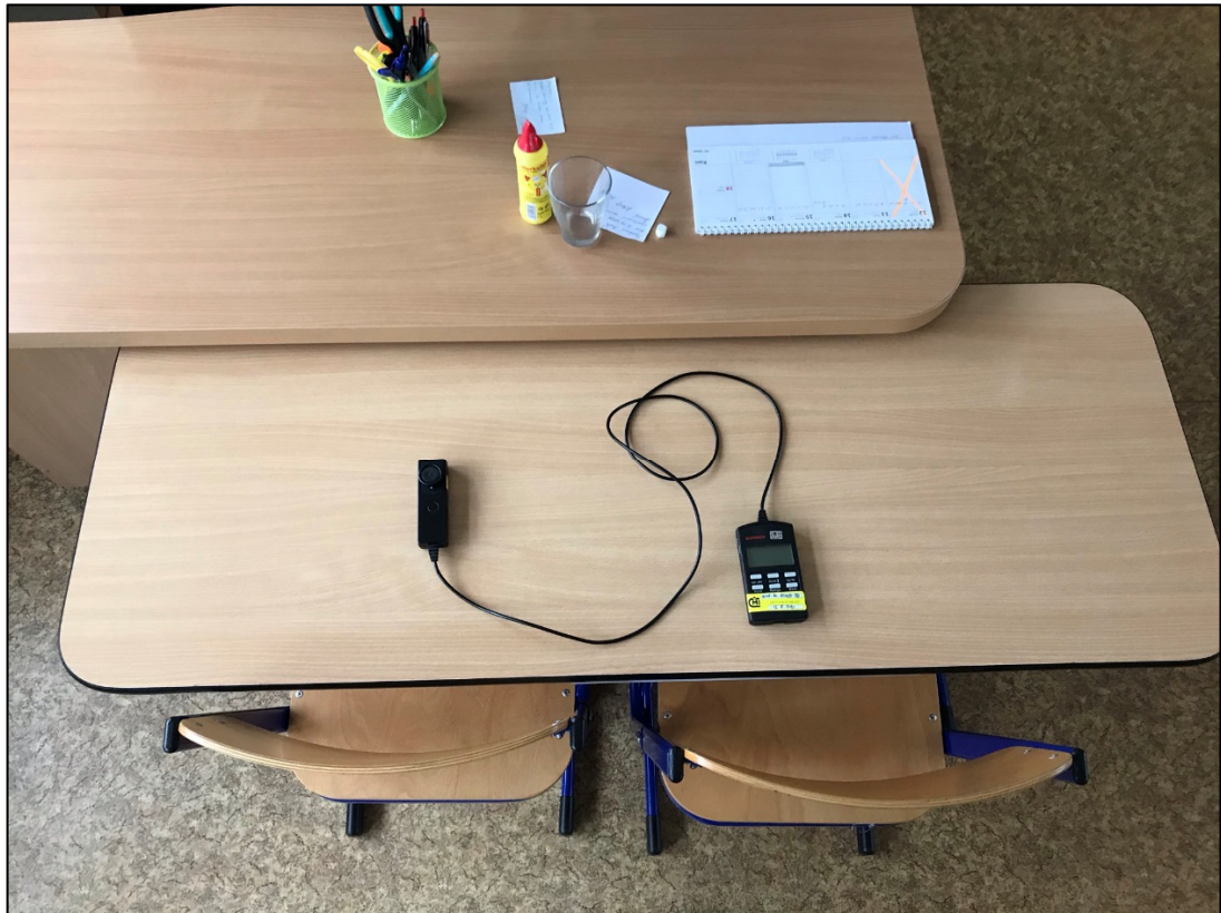
Obr. 29 – Měření osvětlenosti vodorovné roviny v interiéru
