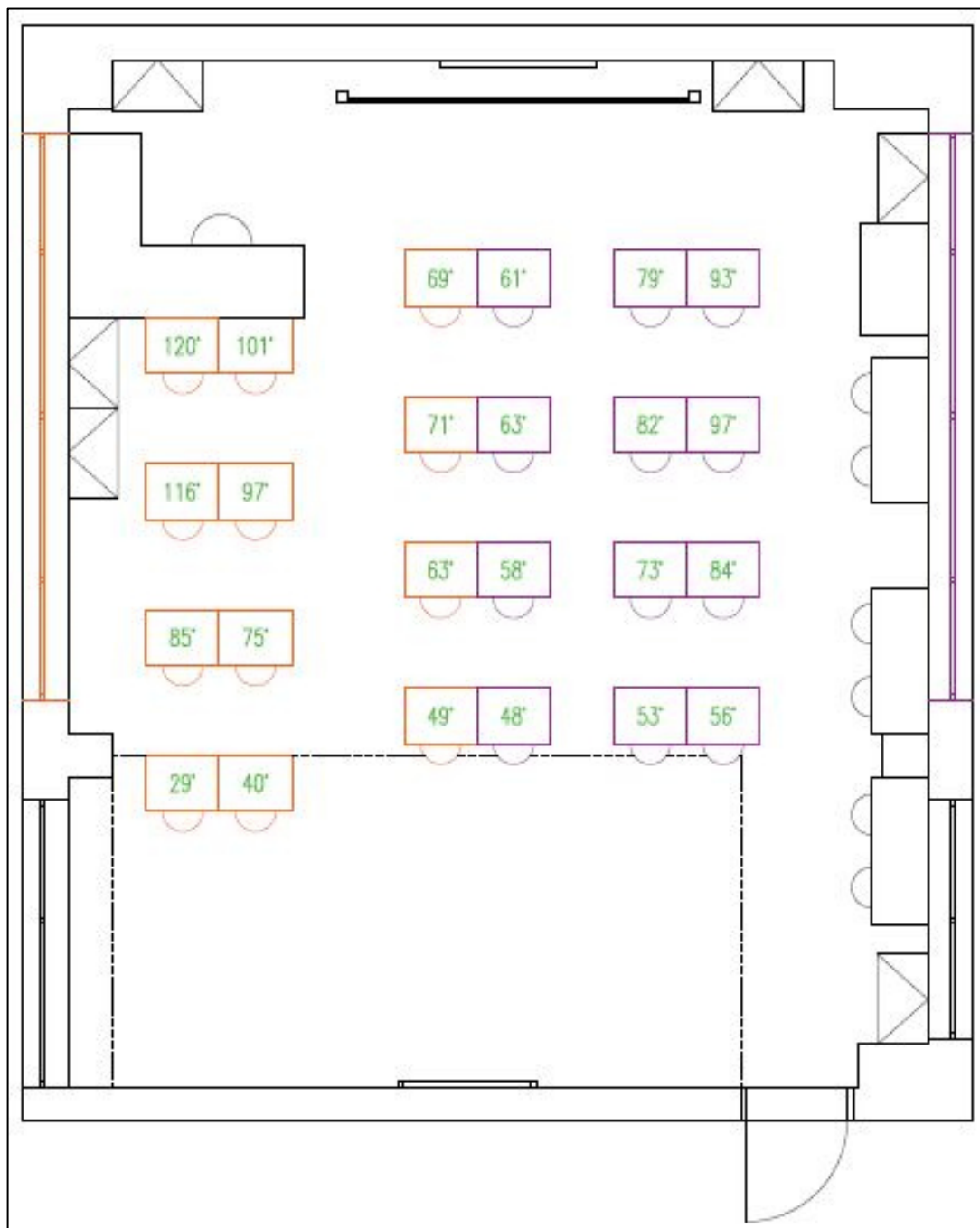
Obr. 66 – ZŠ Rakovského v Praze, učebna III.A, výhled – vodorovný úhel
