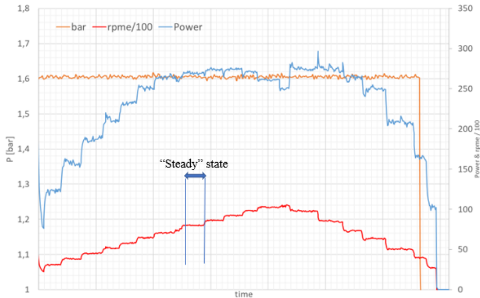
Obrázek 2.2: Příklad raw dat pro jeden tlakový poměr - otáčky a elektrický výkon - a znázornění ustáleného stavu
