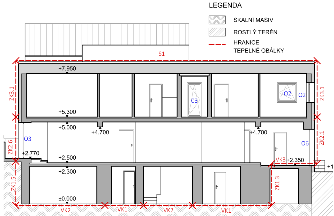
Obr.22 – Hranica tepelnej obálky – rez AA' - navrhovaný stav
