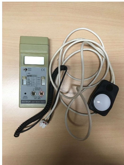
Obr. 18: Fotografie luxmetru EXTECH
