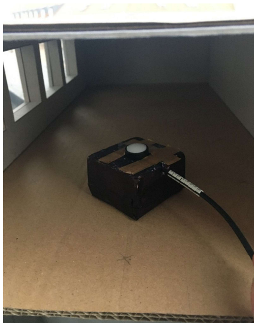
Obr. 25: Pohled na fotonku luxmetru při měření prvního modelu
