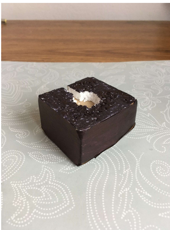
Obr. 20: Fotografie podstavce pro umístění fotonky luxmetru
