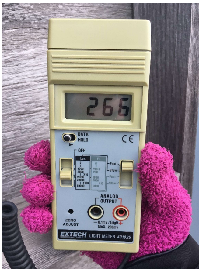
Obr. 21: Fotografie luxmetru, který měřil osvětlenost venkovní nezacloněné vodorovné roviny
