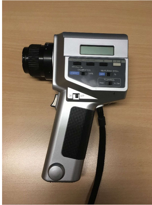
Obr. 19: Fotografie použitého jasoměru Konica Minolta Luminance Meter LS-110
