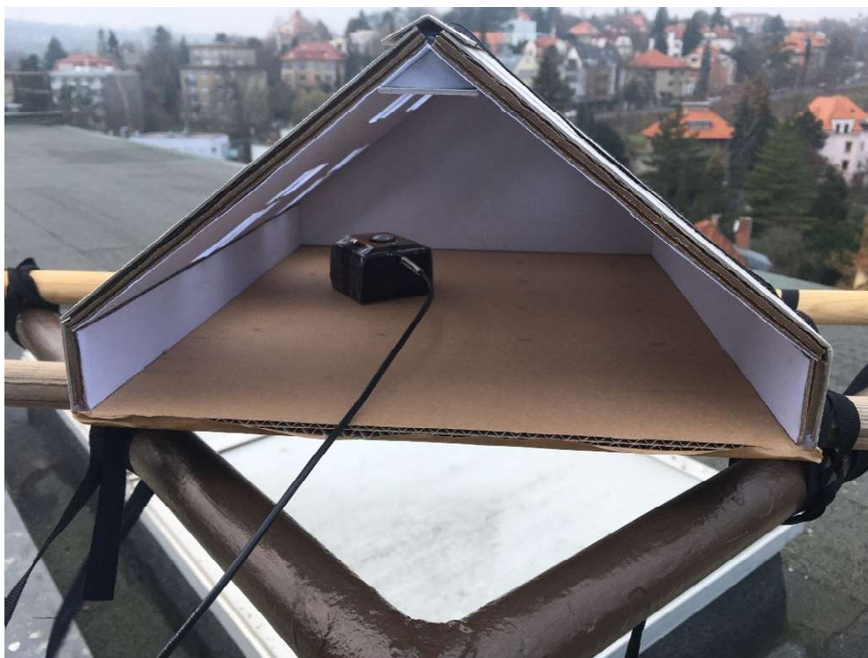
Obr. 31: Pohled na fotonku luxmetru při měření třetího modelu
