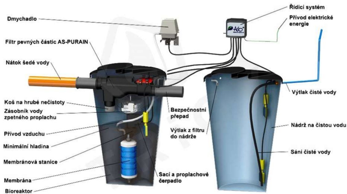
Obrázek 22 Systém pro recyklaci šedé vody AS-GW Aqualoop [25]
