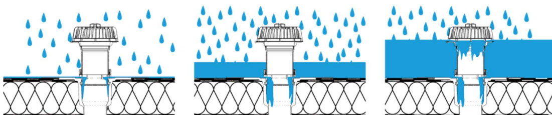
Obrázek 15 Střešní vtok v jednotlivých fázích: 1 – běžná intenzita srážek, 2 – přívalové deště, 3–15 min přívalových dešťů. [19]
