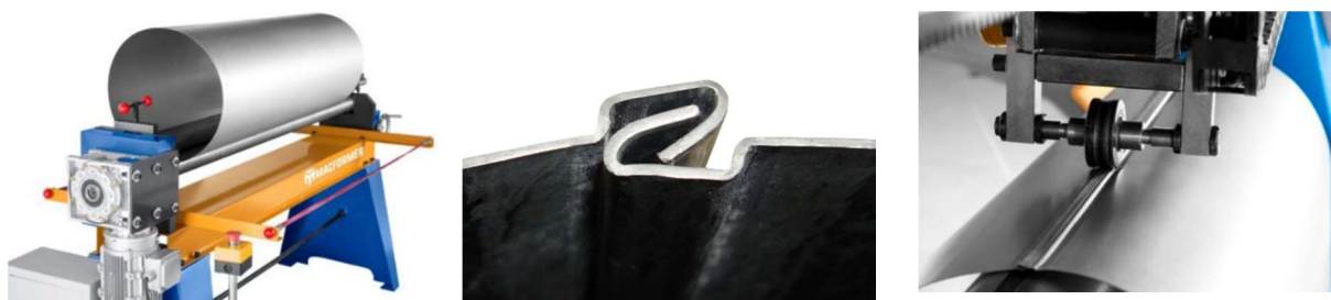
Obrázek 3. Hladké kruhové potrubí – zakružovací stroj; ležatý lem před falcováním; falcování podélného spoje.
