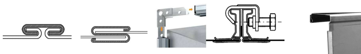
Obrázek 12. Příčné spoje – Nasuvné "C" a "S" lišty; zasunutí rohovníku do lišty; stahovací svorka; TDC bezpřírubový profil.
