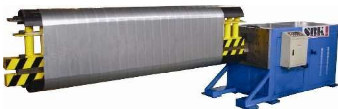
Obrázek 17. Výroba oválného potrubí – ovalizér.
