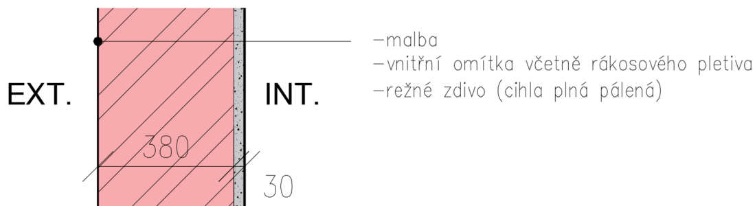
Obrázek 39 - skladba obvodové stěny ve stávajícím stavu
