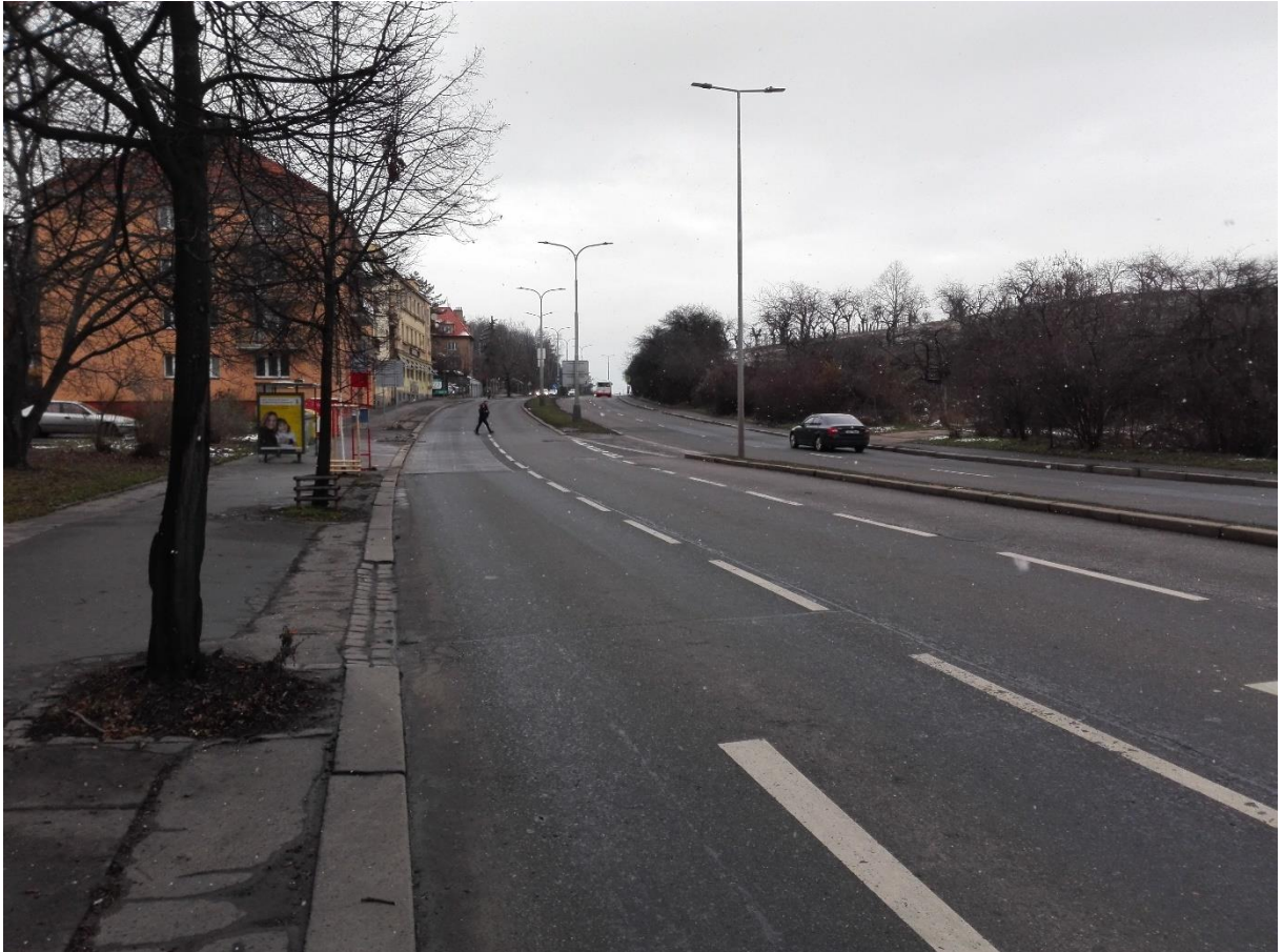
1-20 Zastávka Balkán ve směru ke křižovatce Jarov. Patrné rozšíření jízdního pásu pro umístění levého odbočovacího pruhu. Dále je zde vidět velmi úzký střední dělicí pás cca 0.8 m široký.
