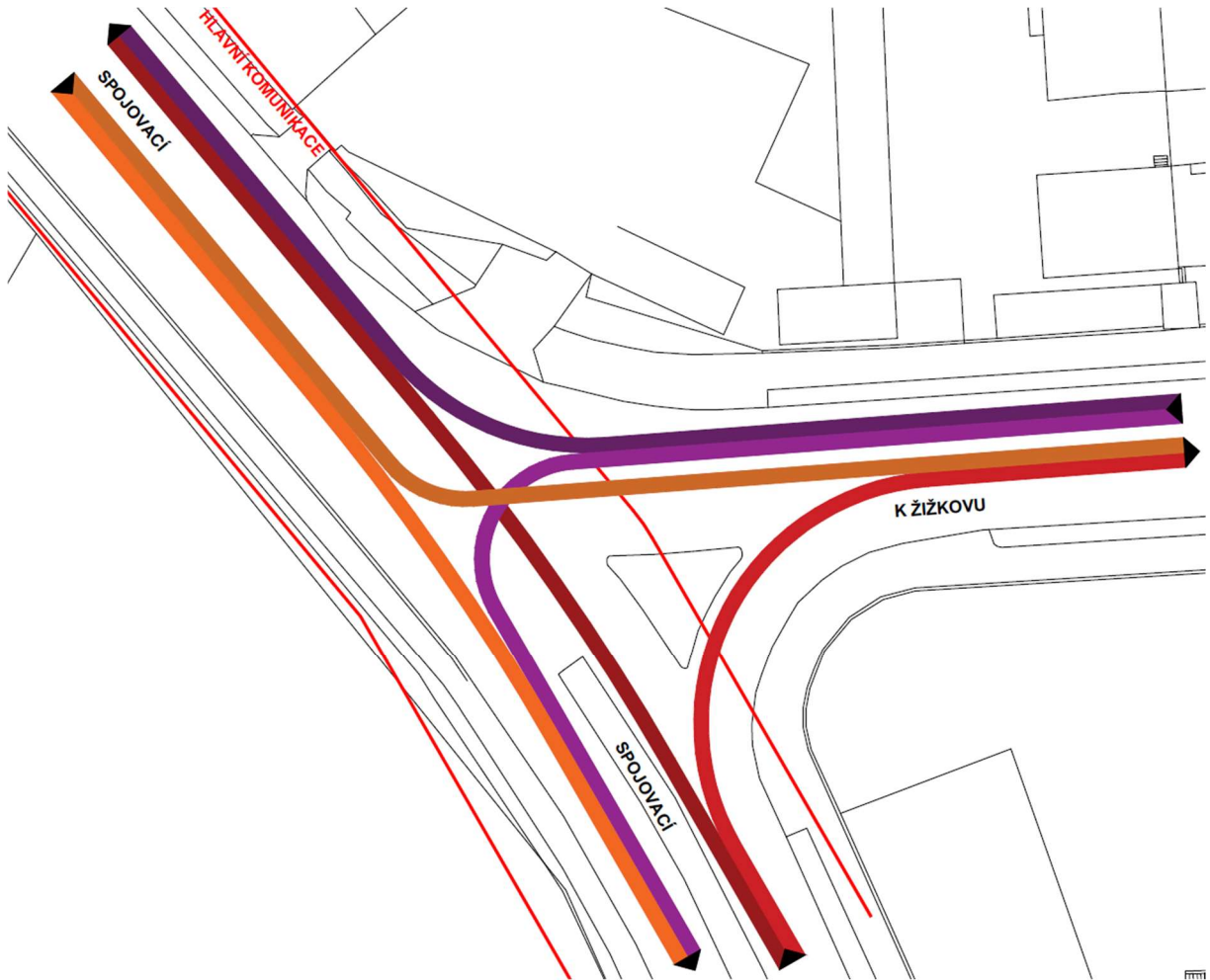
Figure 6-6 – Schematické zobrazení hlavních a vedlejších směrů odbočení
