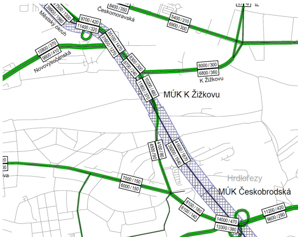
Figure 6-8 - Denní intenzity vozidel (všechna / nad 3.5 t mimo MHD), Rok 2030 varianta včetně VR 22 II a BR 23 (5)
