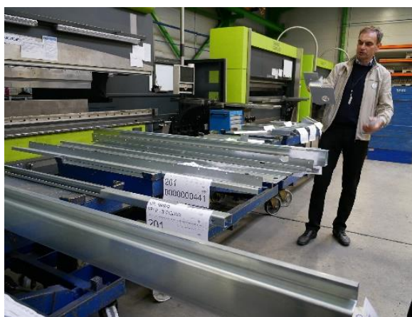
Obr. 2.9 Pohled na výsledné ohýbané profily, v pozadí ohraňovací lis – výroba firmy KOMA MODULAR s. r. o, převzato z [11]
