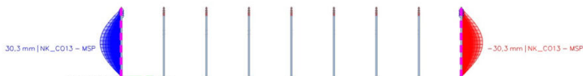
Obr.85: Výsledná maximální deformace sloupu
