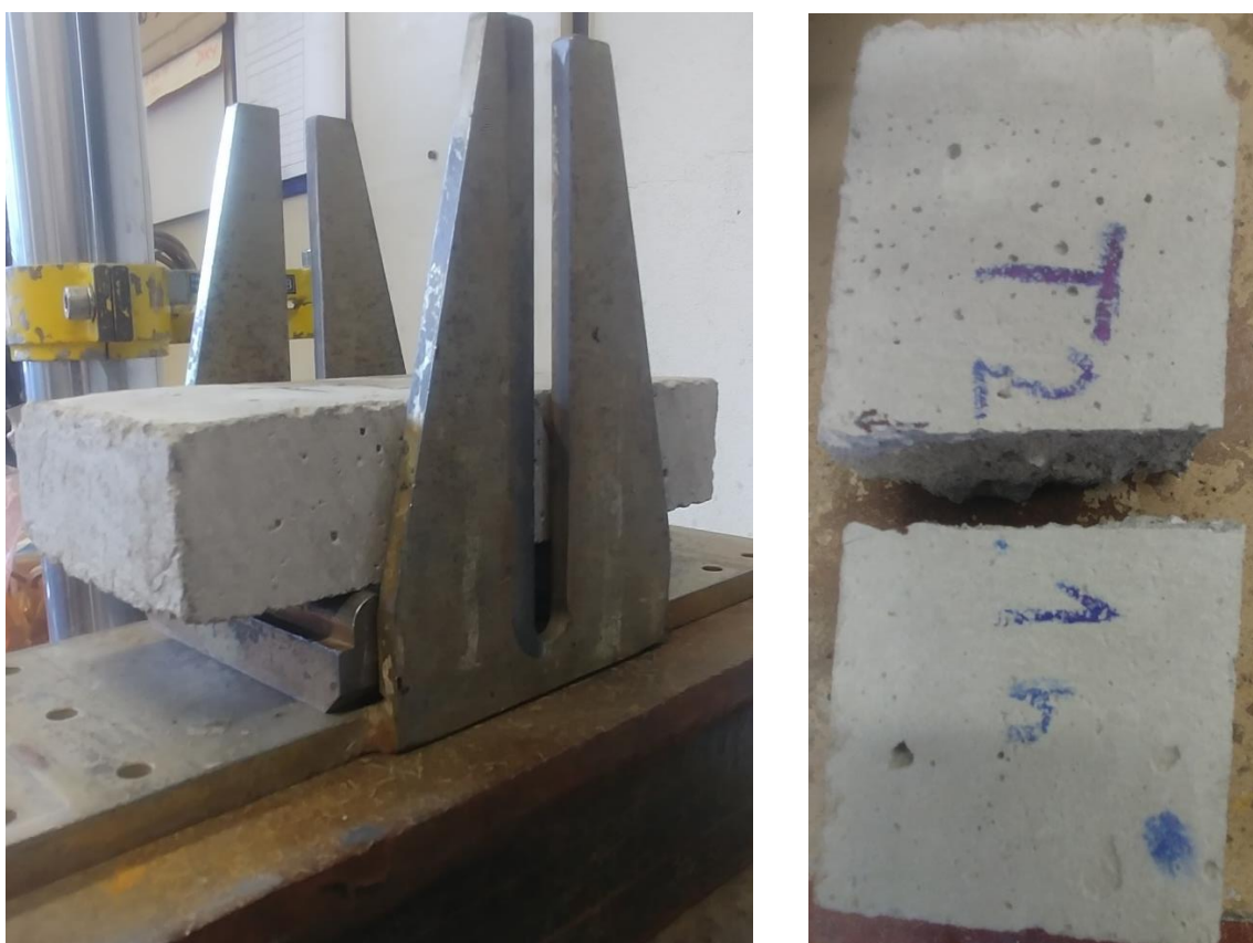
Obrázek 25 Testování bočnice bloku v tahu za ohybu
