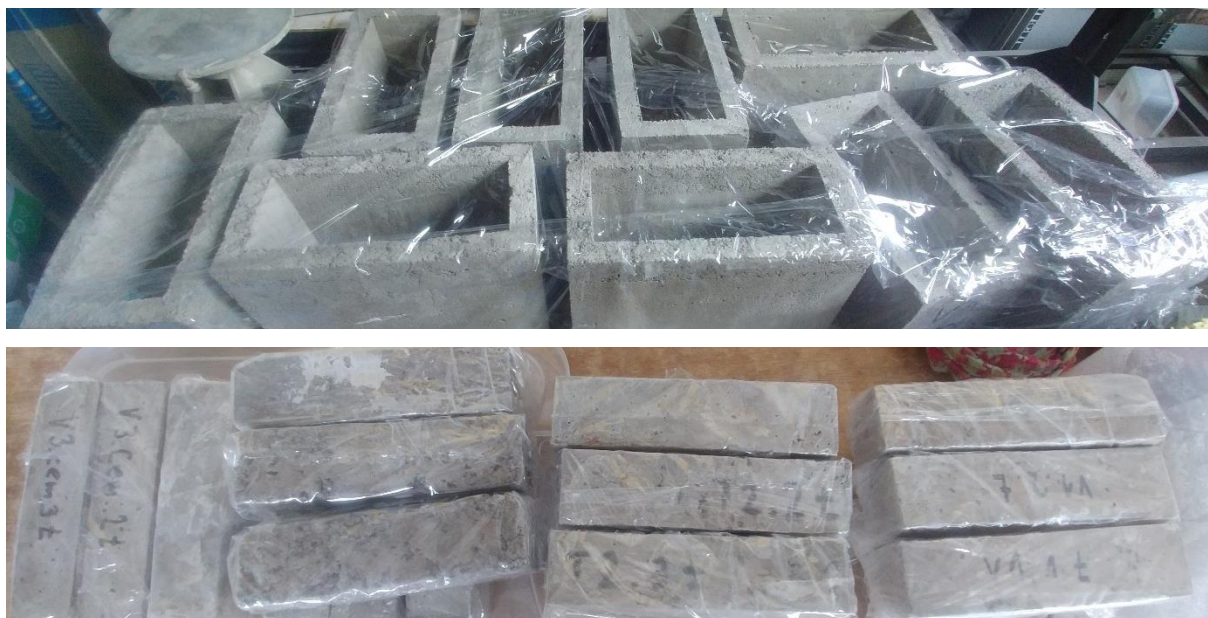
Obrázek 31 Zabalené vzorky během zrání betonu
