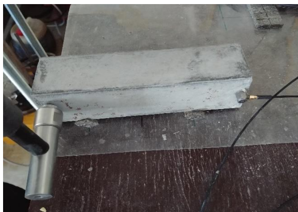
Obrázek 17 Schéma měření příčného kmitání (Horych, 2019)
