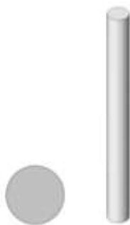
Obrázek 3.4 Ukázka LOG 200 u piloty [13]
