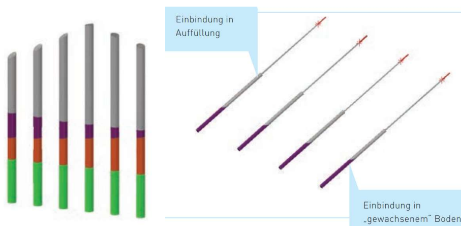
Obrázek 3.3 Vlevo – jednotlivé geologické vrty, vpravo – zemní kotvy, které prochází jednotlivými vrstvami zeminy [13]
