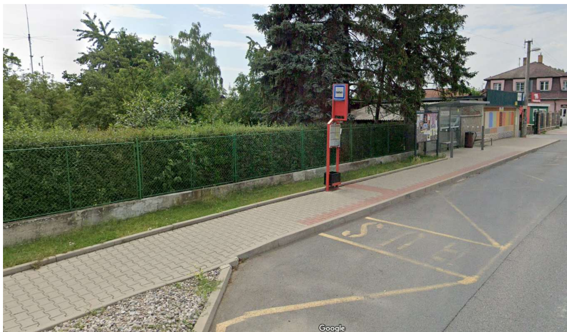
Obrázek 11: Autobusová zastávka s kombinací přirozenou a uměle vytvořenou vodící linií pro nevidomé a slabozraké.
