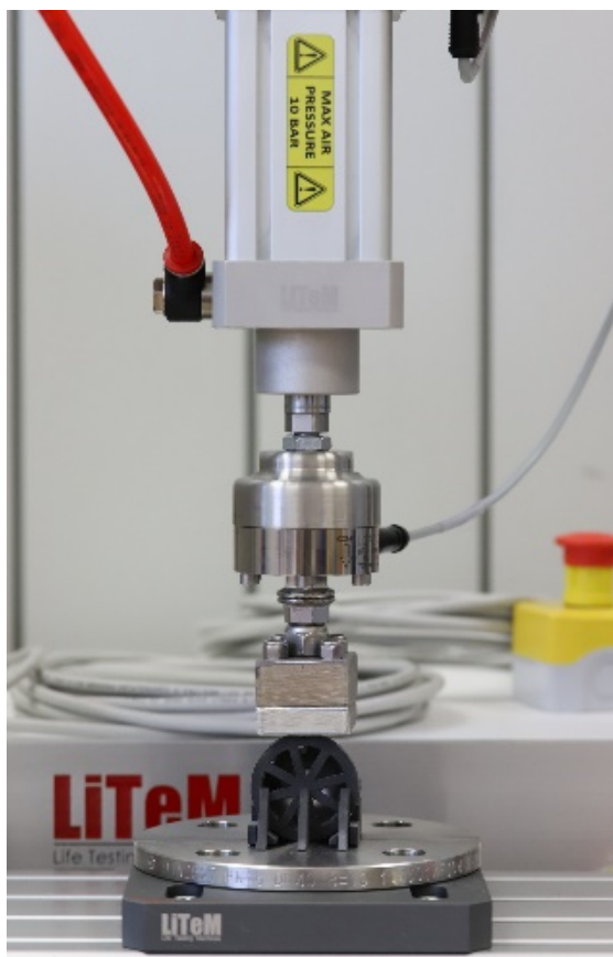
Obr. 50: Umístění testovacího vzorku v lisu pomocí ustavovacího přípravku
