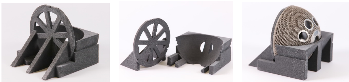
Obr. 48: Ustavovací přípravek pro zajištění rovinnosti zkoušeného vzorku
