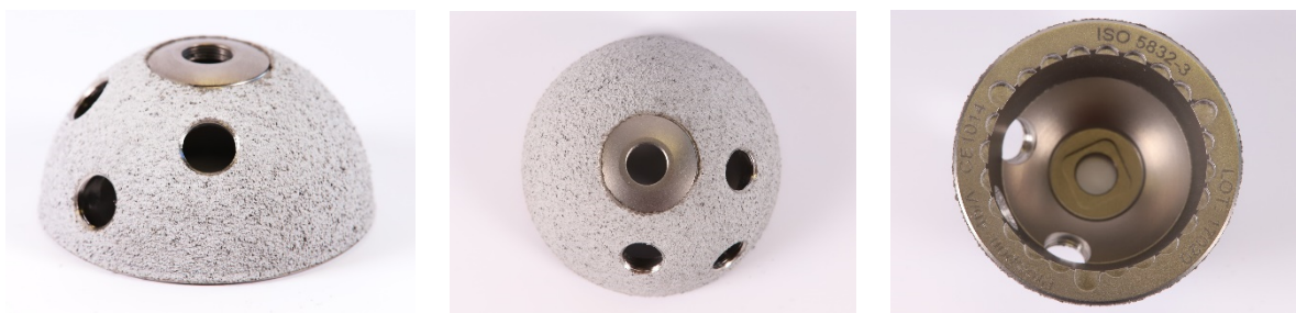
Obr. 47: Obráběné acetabulární komponenty (před zatěžováním)
