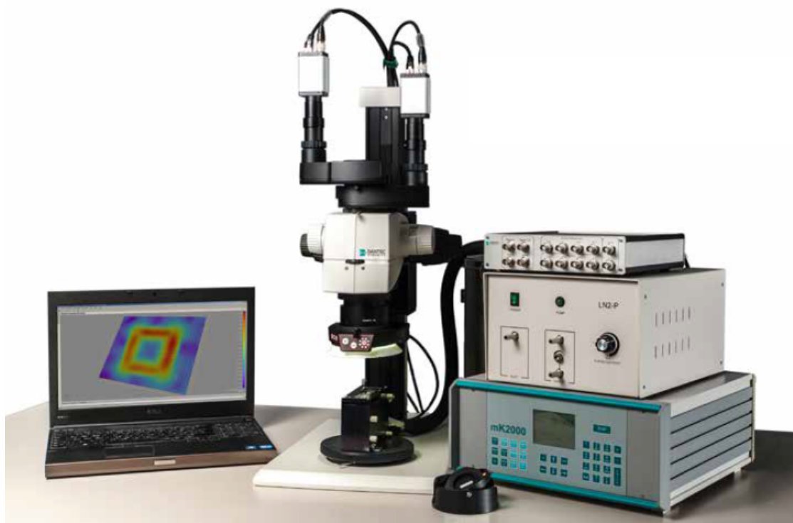
Obr. 66: 3D korelační systém Micro DIC Q-400 od firmy Dantec Dynamics [52]
