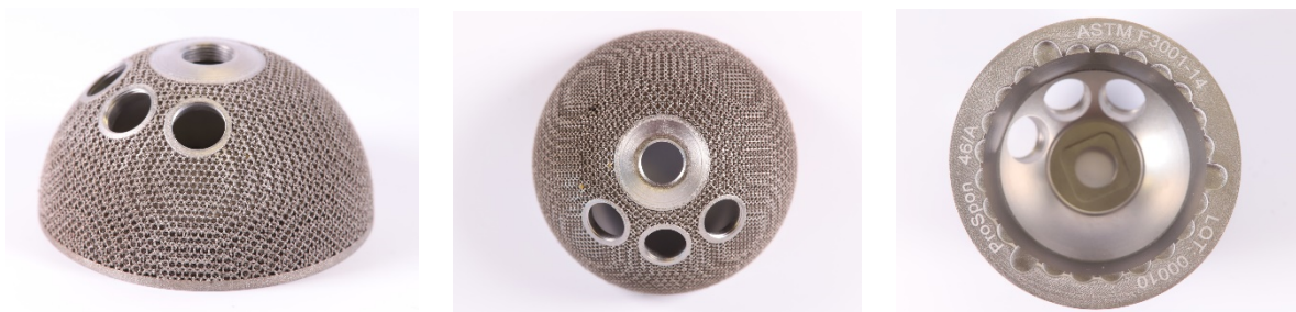
Obr. 46: 3D tištěné acetabulární komponenty (před zatěžováním)
