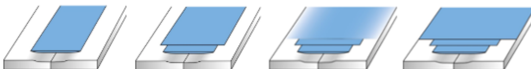
Obrázek 28: Stupně jakosti tmelení SDK příček, zleva Q1 – Q4 [51]
