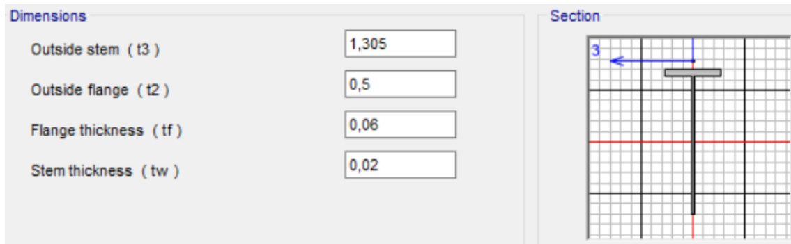
Obr. 40: Průřez krajního příčnicku pod kolejovým ložem
