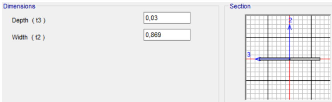
Obr. 37: Průřez styčnickového plechu u závěsů
