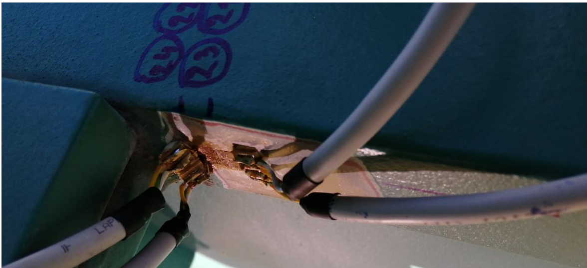
Obr. 96: Tenzometry u konzoly u pravého táhla (T9)
