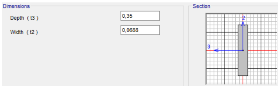
Obr. 44: Průřez krajní podélné výztuhy
