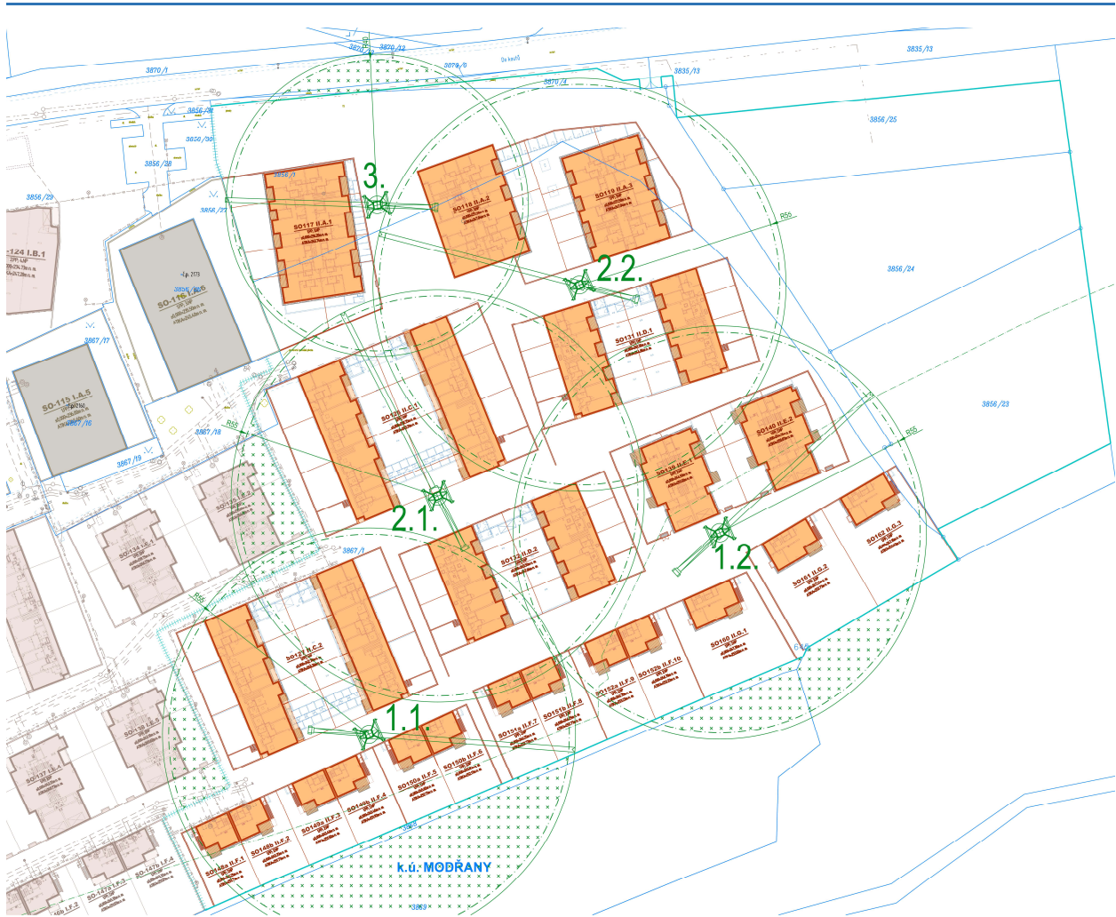
Obrázek 6 Situace rozmístění věžových jeřábů
