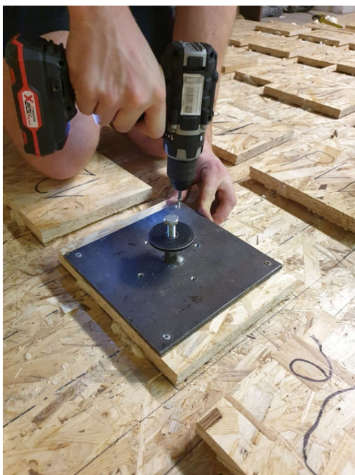
Obr. 33: Připevnění ocelového plátu k vzorku (zdroj autor)
