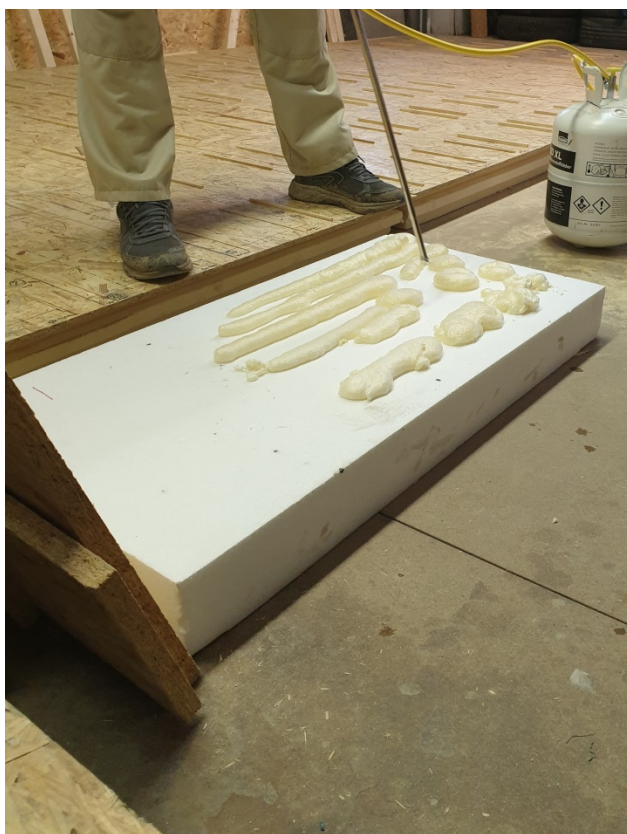
Obr. 25: Provedení zkušebních pruhů lepidla před aplikací na model (zdroj autor)
