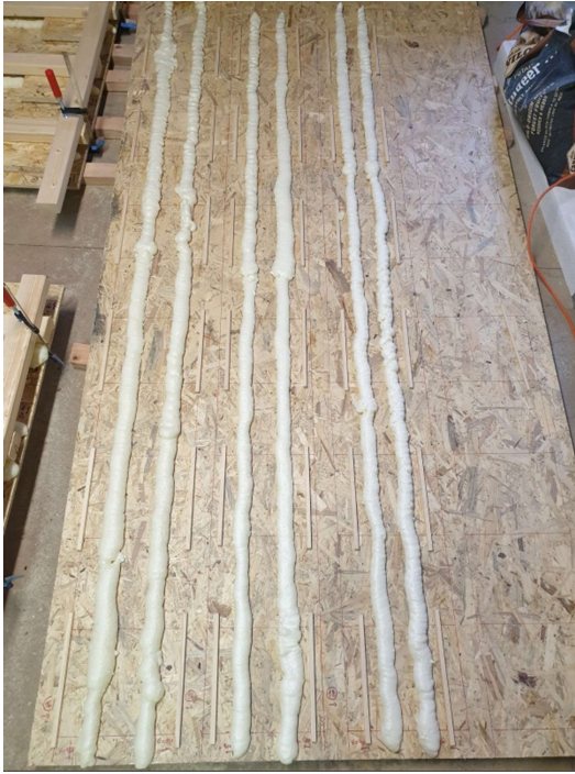
Obr. 30: Čerstvě nanesené PUR lepidlo před kladením vzorků (zdroj autor)
