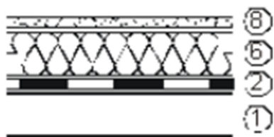
Obr. 4: Jednoplášťová střecha s opačným pořadím vrstev (převzato z [ http://fast10.vsb.cz/studijni-materialy/ps4/5.html ])
