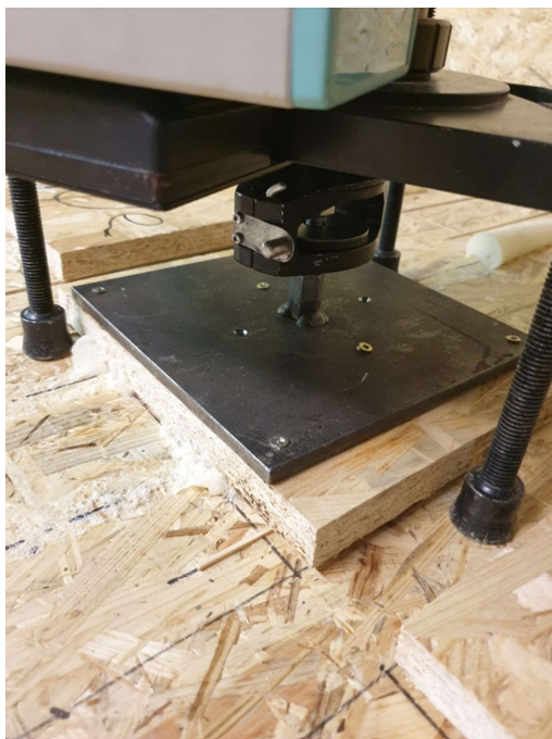
Obr. 35: Připevnění ocelového plátu k výtahoměru (zdroj autor)
