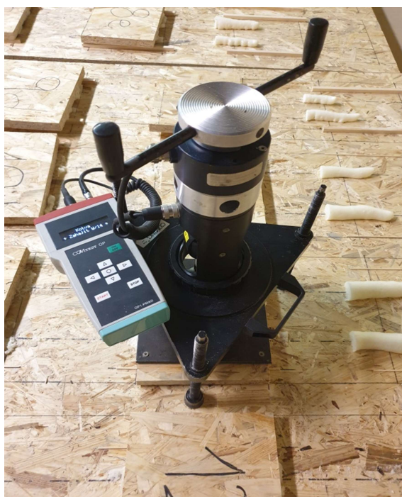
Obr. 34: Připravený výtahoměr před odtržením vzorku (zdroj autor)
