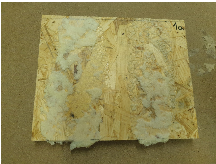
Obr. 37: Detail vzorku po odtržení (osová vzdálenost 120 mm, nerovnost 2 mm),(zdroj autor)
