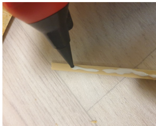
Obr. 17: Lepení distančníků (zdroj autor)
