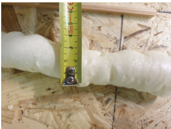
Obr. 27: Měření šířky pruhu PUR lepidla (zdroj autor)
