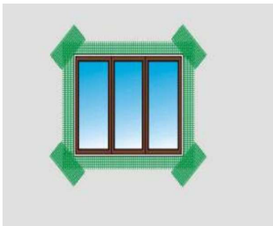
Obrázek 11 - Vyztužení rohů otvorů [31]
