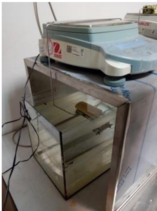
Obr. 55 – Fotka z měření Archimédovy hmotnosti odebraného vzorku, podzim 2020. (zdroj: Ing. Miloš Jerman, PhD.)
