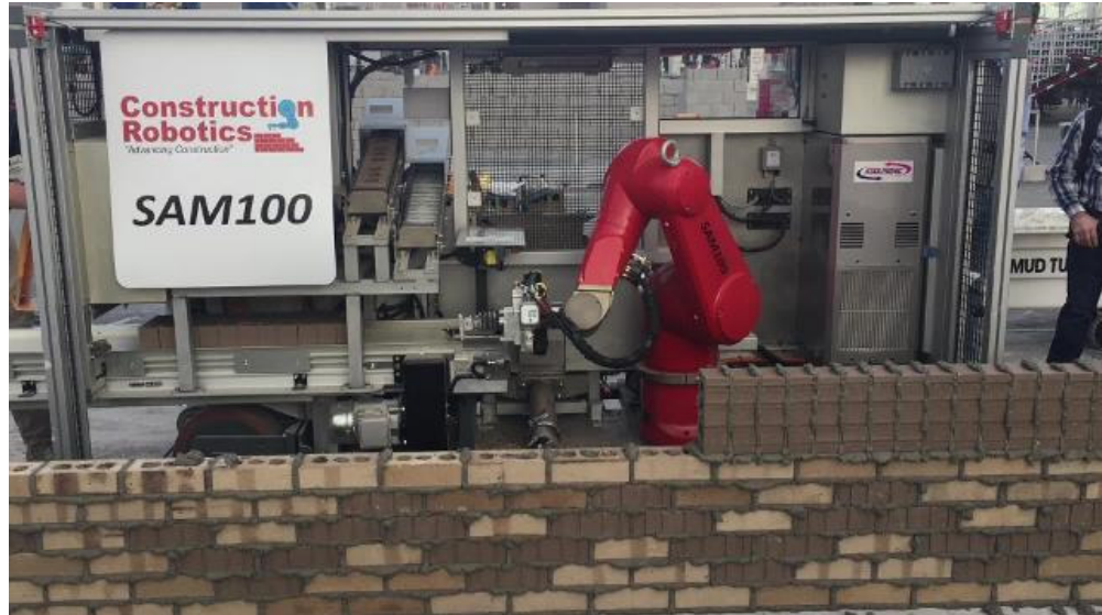
Obrázek 2 – Ukázka patentu Brick Laying System, převzato z [13]
